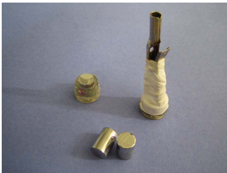
Figura II. 8 Componentes para la disposición de los electrodos de trabajo en el interior de la celda.
