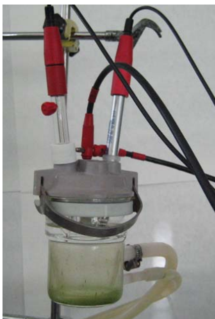
Figura II. 6 Disposición de los Electrodos en la celda electroquímica vertical.
