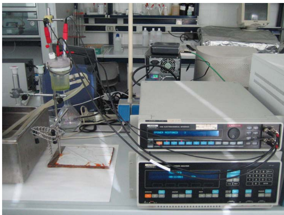
Figura II. 7 Conexión de los electrodos al Potenciostato-Analizador SOLARTRON.
