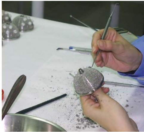
Figura I. 4 Proceso manual de la aplicación del recubrimiento sobre prótesis
