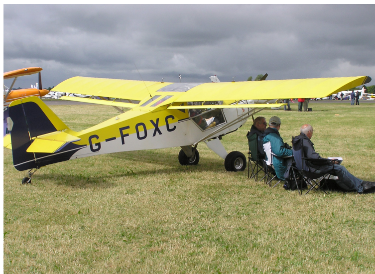
Figura 2: Imagen de un Denney Kitfox en la que se claramente el ala alta, por encima del fuselaje . En la punta del ala se puede ver la forma del perfil alar . En la parte trasera del ala , separado del borde de salida , hay flaperones . La forma en planta del ala es rectangular. Obtenida de Arpingstone [Public domain] 2005a.
