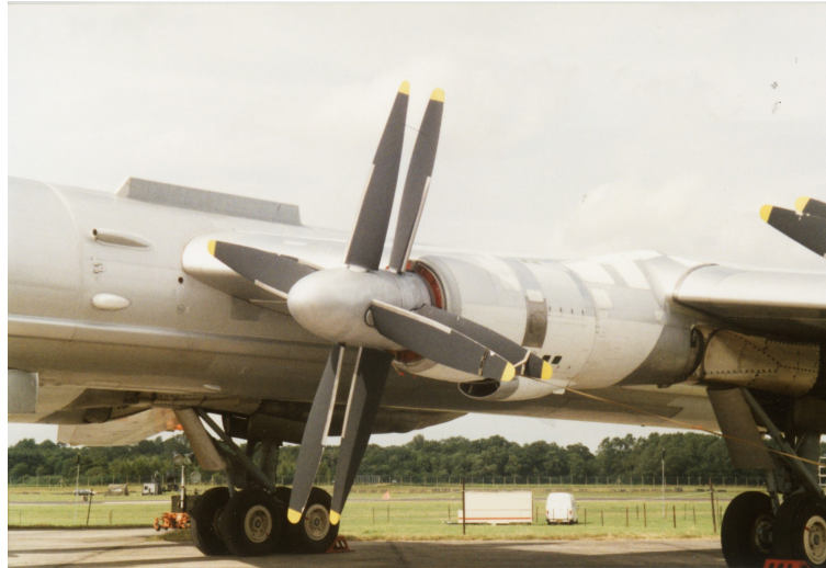
Figura 9: Motor turbohélice ( turbohélice , turbohèlix , turboprop ) Kuznetsov NK-12M, con la hélice de ocho palas. Obtenida de Petebutt [Public domain] 1993.
