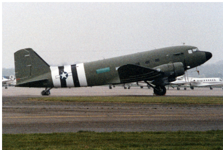
Figura 5: Tren convencional en un Douglas C-47 Skytrain. Nótese que la batalla mide buena parte de la longitud del fuselaje, y que la rueda de cola es mucho más pequeña que las ruedas del tren principal . Obtenida de Jan Arkesteijn [Public domain] 1985.
