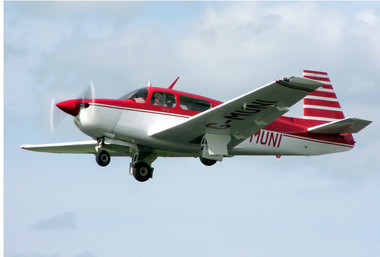
Figura 6: Tren triciclo en un Mooney M20J. Nótese que el tren principal es retráctil y puede esconderse en el interior del ala, mientras que el tren de morro se retrae en la zona delantera del fuselaje, por debajo del motor. Obtenida de Arpingstone [Public domain] 2005b.
