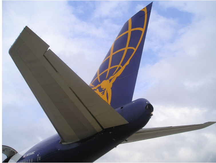
Figura 4: Imagen de los estabilizadores horizontal y vertical en la cola de un Boeing 747-200. Los timones de profundidad y dirección son visibles en la parte trasera de los estabilizadores. Obtenida de Dtom [Public domain] 2008.
