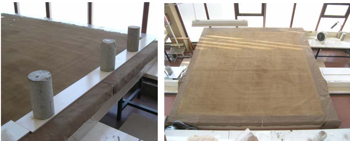
Fig. 49 y 50. Adhesión de bandas de tensión provisional.
