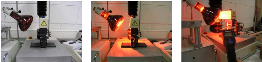
Fig. 21, 22 y 23. Proceso de reversibilidad de las muestras mediante calor por infrarrojos.
