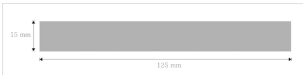
Fig. 11. Croquis de probeta para ensayo de pelado.
