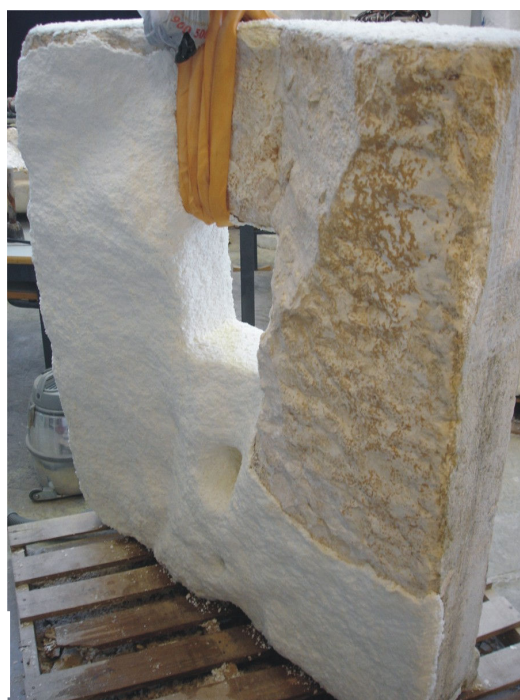
Figuras 45 y 46. Aplicación de la solución química de empacos de
