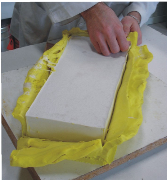
Figura 84. Separación del tabique de plastilina del molde de silicona.
