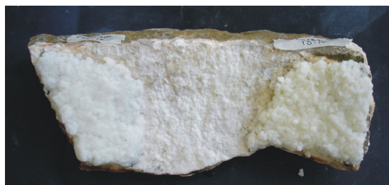
Figuras 40 y 41. Detalle de la capa de arbocel, para reblandecer la fina capa de mortero
