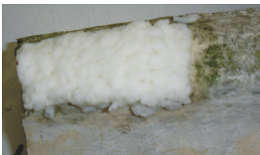
Figura 50. Detalle de la papeta de biocida al 5% en agua desionizada
