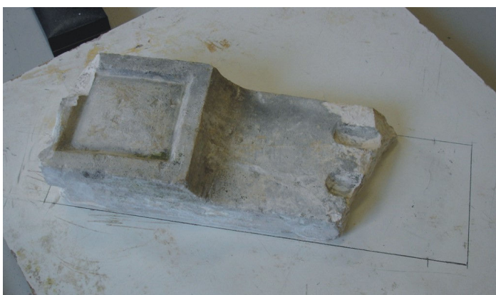
Figuras 82 y 83. Preparación del fragmento ornamental para la reconstrucción en plastilina del faltante. Seguidamente realización del tabique de plastilina y vertido de la silicona al fragmento.
