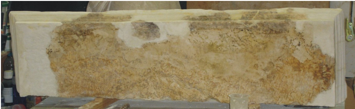
Figura 117. Tono neutro en los morteros de la base de los violines, entonando con la generalidad de la pieza.
