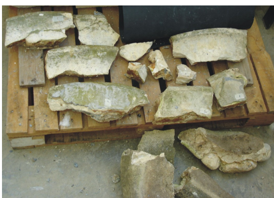
Figuras 17 y 18. Detalles de suciedad superficial y anclajes de pernos de hierro, de una restauración anterior no adecuada.
