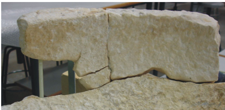
Figura 61. Detalle de sujeción de las piezas con el adhesivo epoxidico y pernos de fibra de vidrio de diferentes diámetros.
