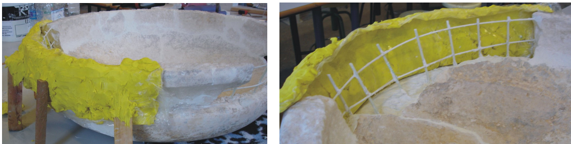
Figuras 67 y 68. Detalle exterior e interior del molde para la aplicación del mortero.
