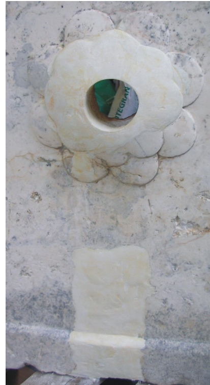
Figura 81. Reconstrucción volumétrica de la flor.
