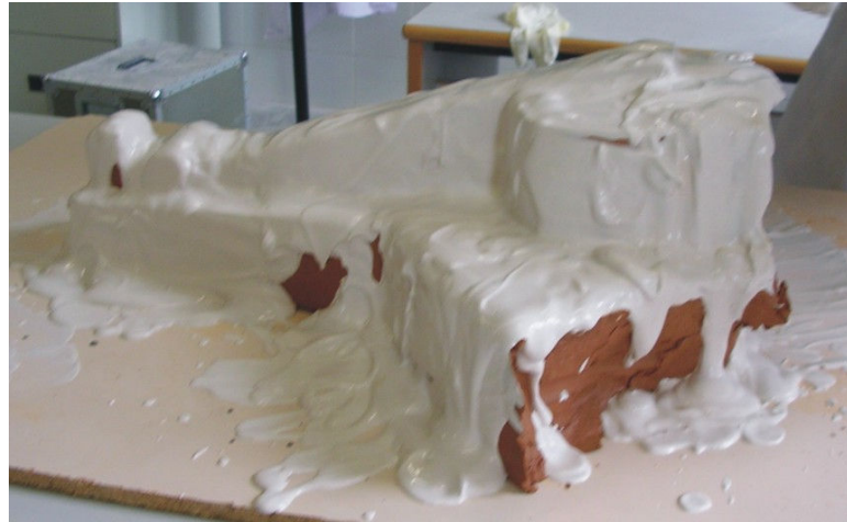
Figura 95. Realización del molde de escayola a la pieza en barro para su posterior réplica en resina.
