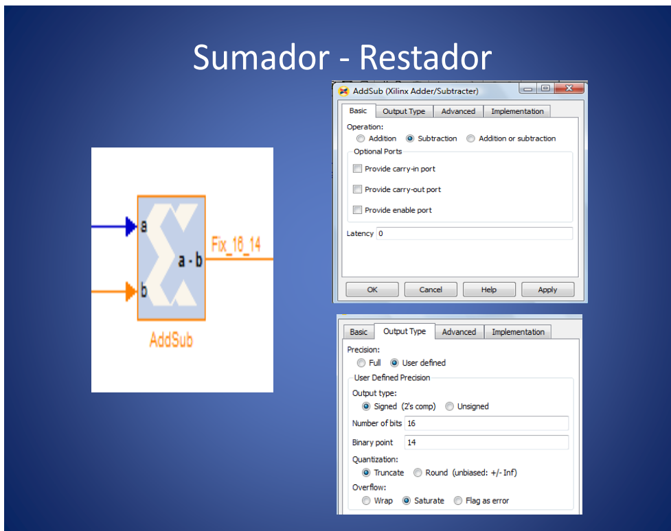
Fig 4.8 Representación de sumadores/restador con System Generator.
