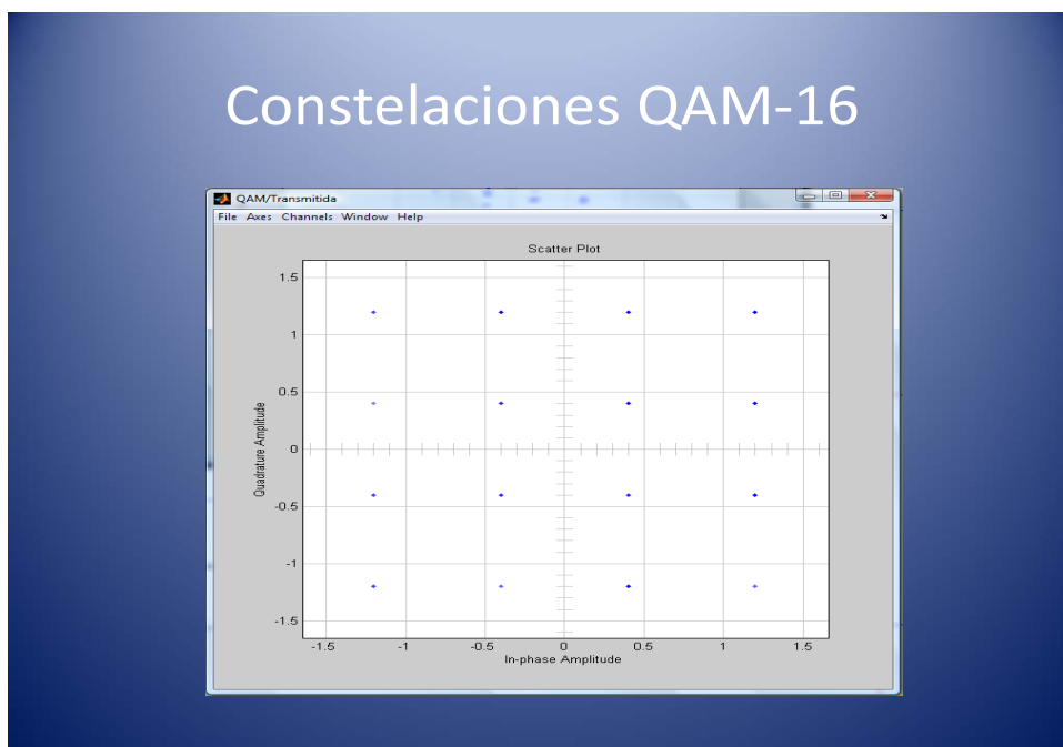
Fig. 3.2 Señal transmitida 16-QAM
