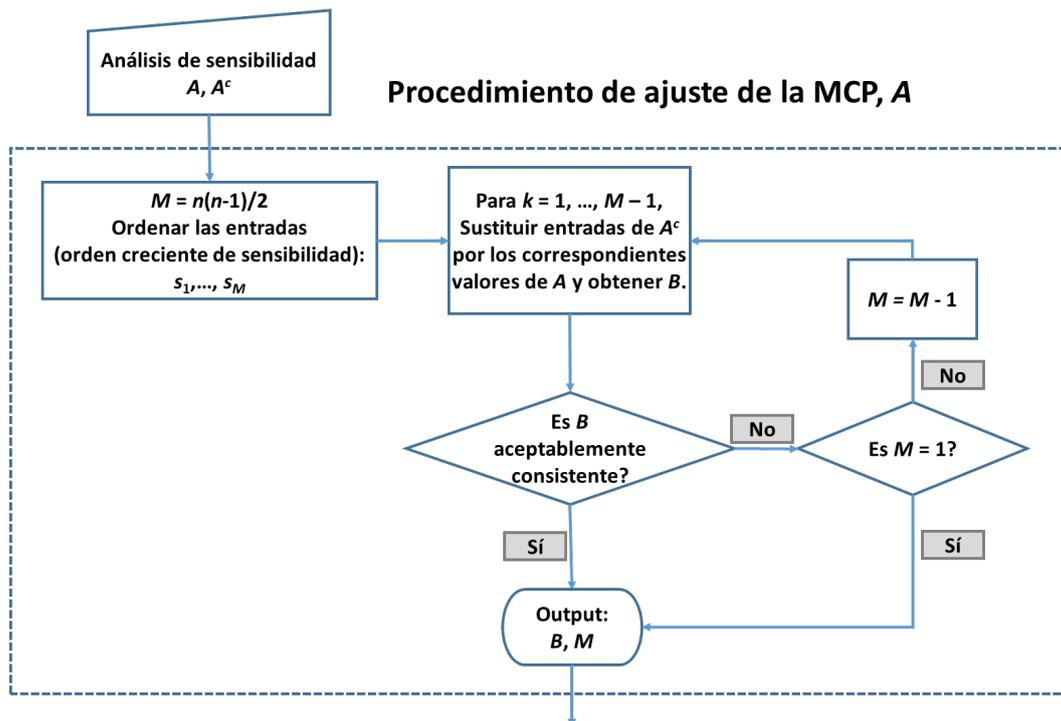
**Figura 3.** Procedimiento de ajuste de la MCP, A
