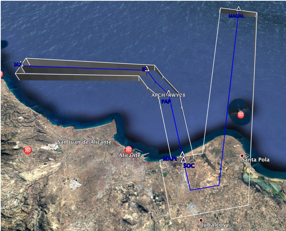
Figura 41: aproximación con protección lateral
