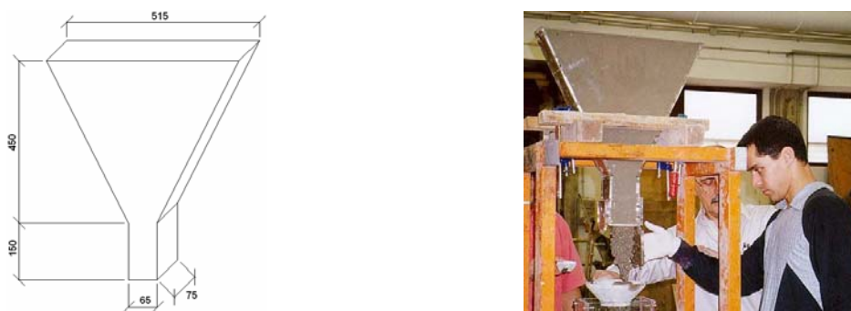
Figura 1.5. Determinación tiempo de flujo. Ensayo embudo en V (UNE 83364:2007). Dimensiones (mm)
