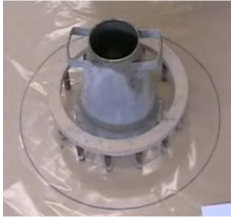
Figura 1.7. Ensayo del anillo japonés (UNE 83362:2007).
