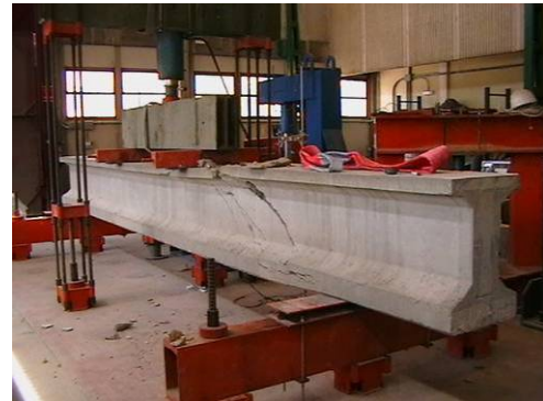
Figura 4.17. Imágenes tras la rotura de la viga armada de HT sin fibras (Viga A)
