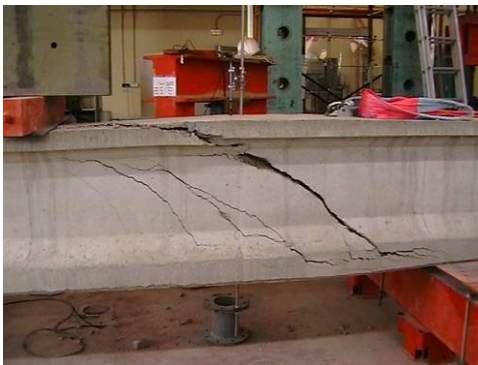
Figura 4.17. Imágenes tras la rotura de la viga armada de HT sin fibras (Viga A)
