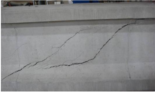
Figura 4.19. Imágenes tras la rotura de la viga armada con fibras (Viga C)
