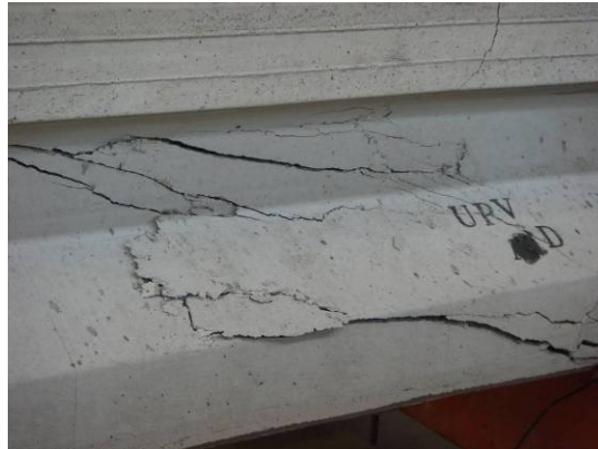
Figura 4.20. Imágenes tras la rotura de la viga pretensada sin fibras (Viga D)
