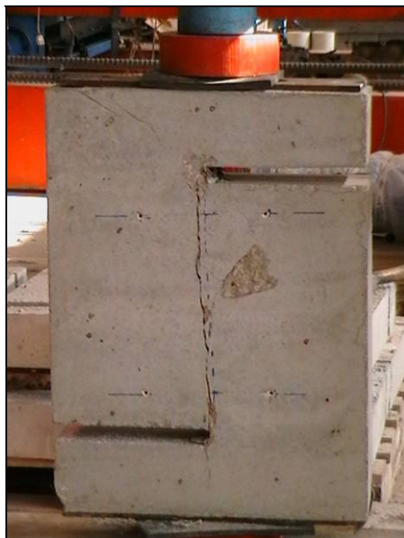
Probeta con armado transversal sin prefisura Probeta con mismo armado pero con prefisura lisa Figuras 4.3.
