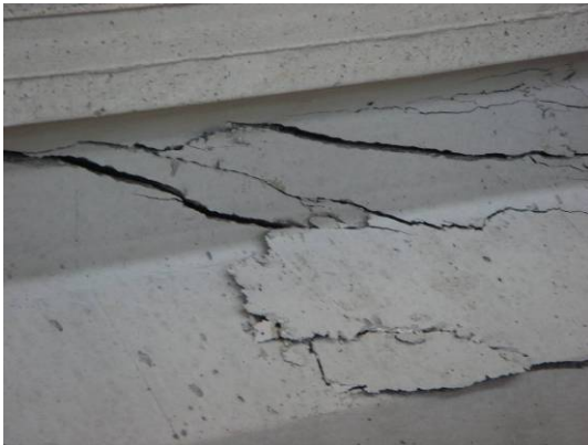
Figura 4.20. Imágenes tras la rotura de la viga pretensada sin fibras (Viga D)
