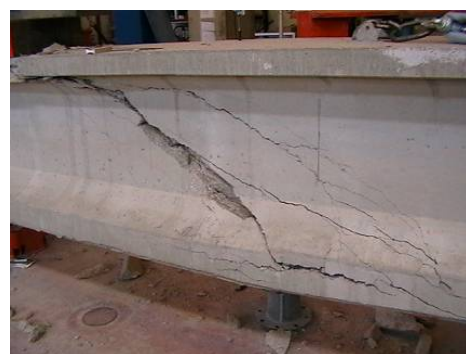
Figura 4.18. Imágenes tras la rotura de la viga armada de HAC sin fibras (Viga B)
