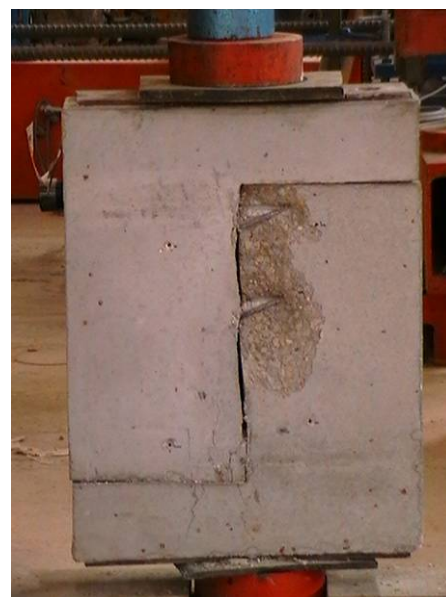
Probeta con armado transversal sin prefisura Probeta con mismo armado pero con prefisura lisa Figuras 4.3.
