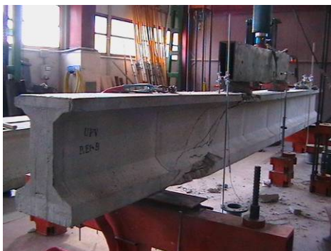
Figura 4.18. Imágenes tras la rotura de la viga armada de HAC sin fibras (Viga B)
