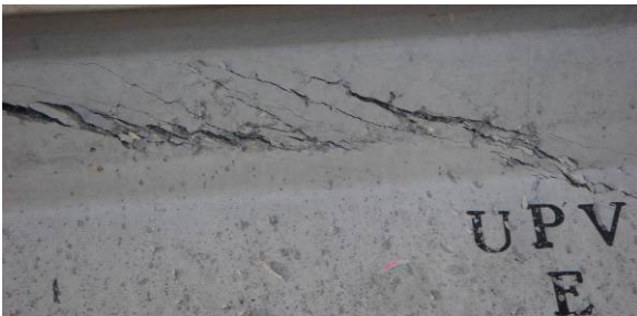
Figura 4.21. Imágenes tras la rotura de la viga pretensada con fibras (Viga E)
