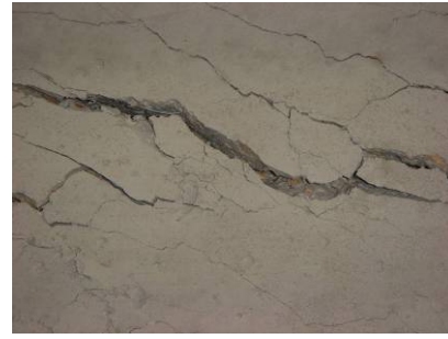
Figura 4.19. Imágenes tras la rotura de la viga armada con fibras (Viga C)
