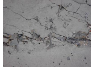
Figura 4.21. Imágenes tras la rotura de la viga pretensada con fibras (Viga E)
