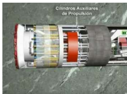
Figura 10: Esquema interior de Tuneladora Doble Escudo
