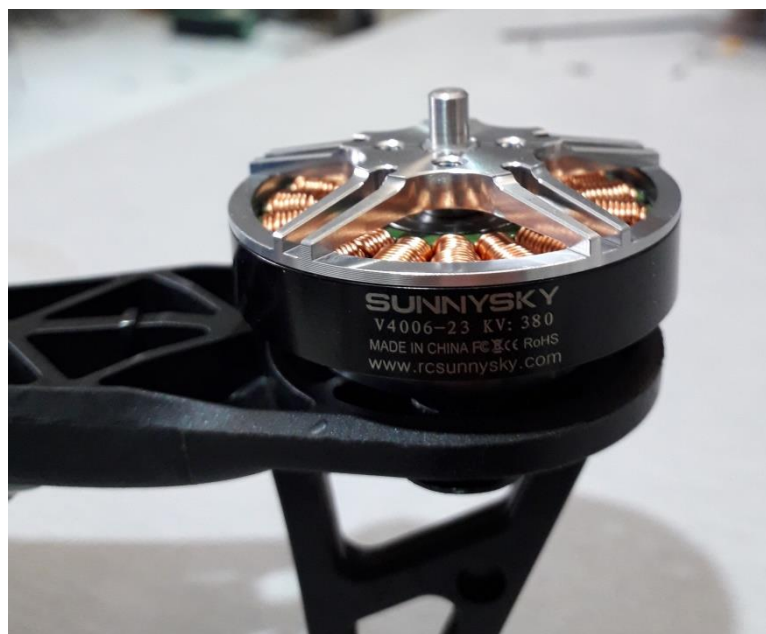
Figura 6.2 Motor montado en el brazo con el acople
