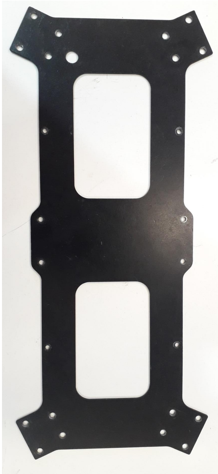
Figura 5.11 Placa superior fabricada por CNC en fibra de vidrio G10
