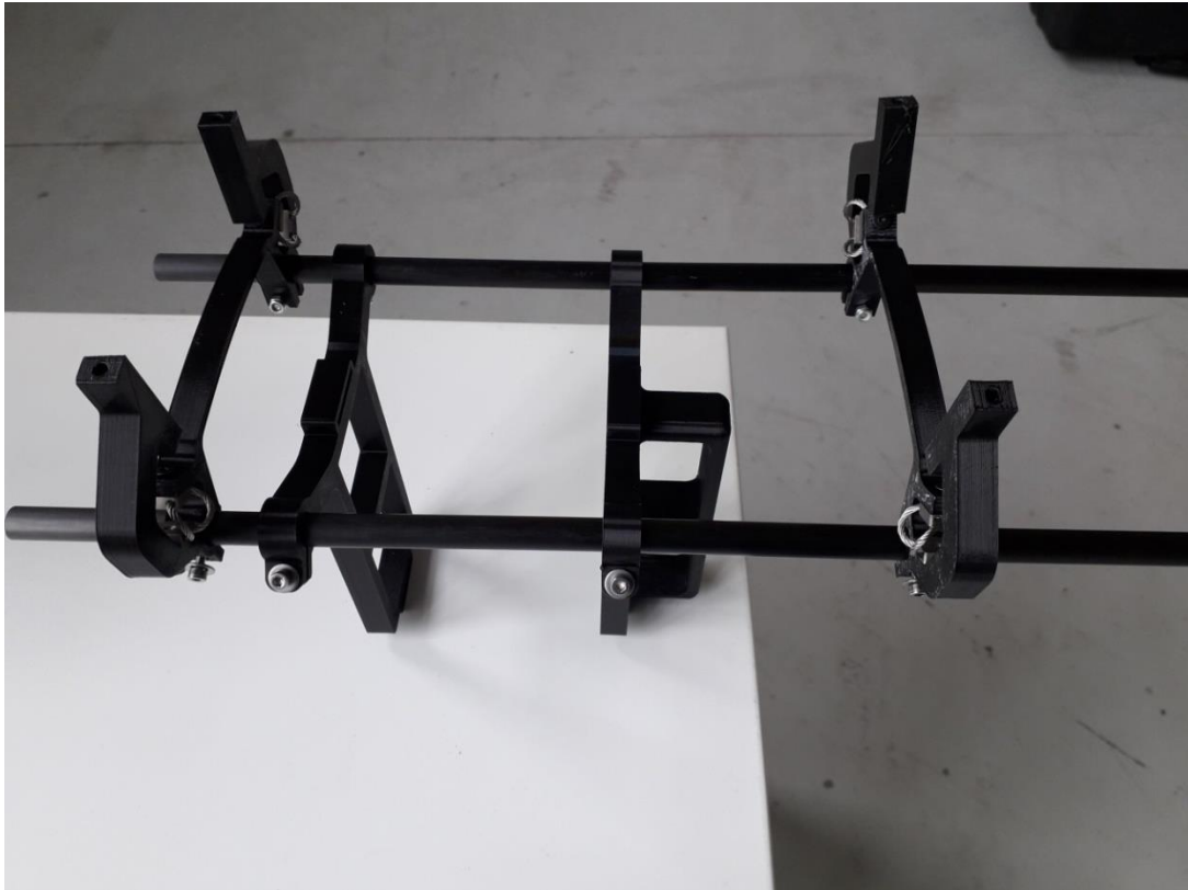
Figura 5.21 Estructura de las cargas de pago y soporte de baterías impreso en 3D 2
