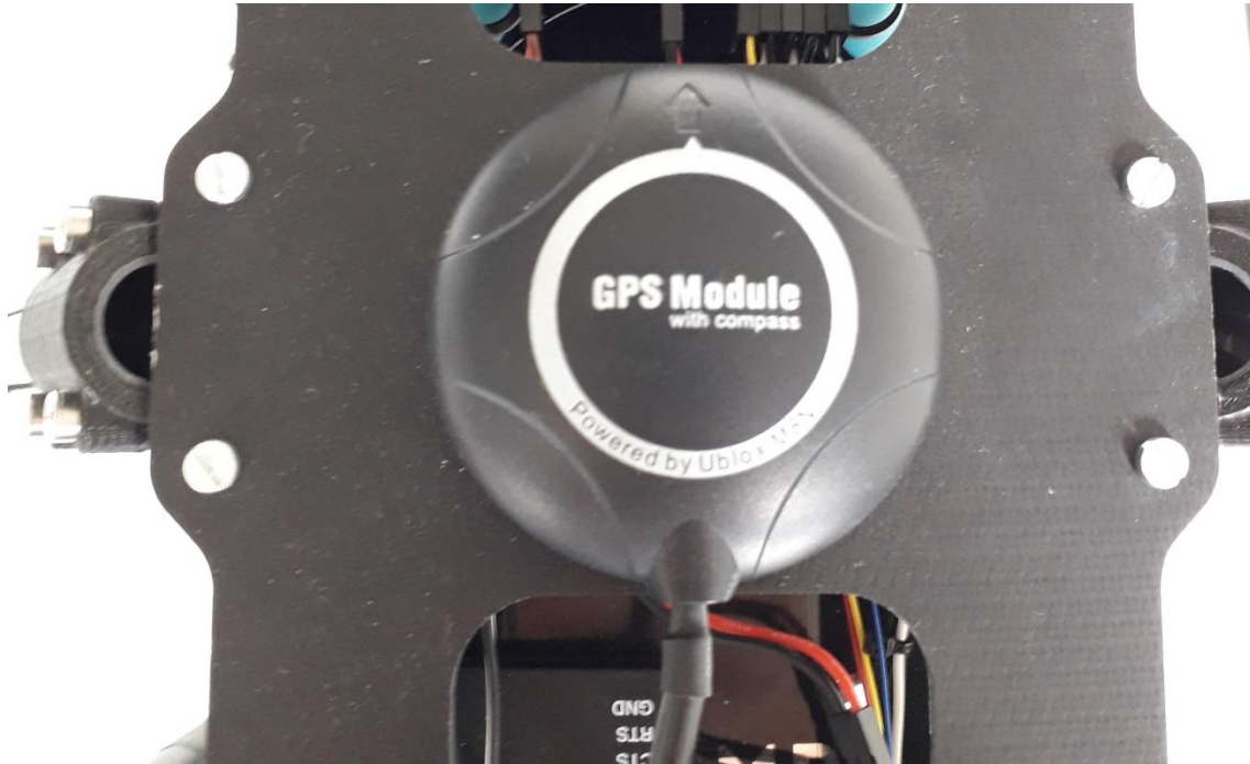
Figura 6.12 Módulo GPS instalado en la placa superior
