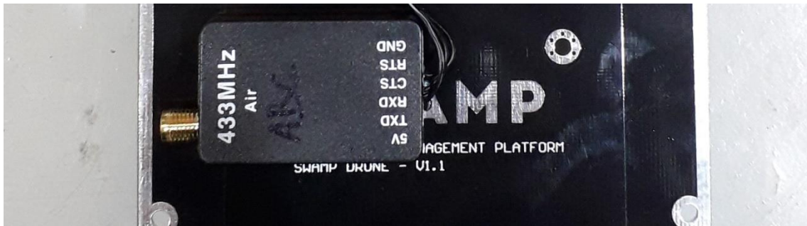
Figura 6.10 Módulo de telemetría ubicado en la PDB
