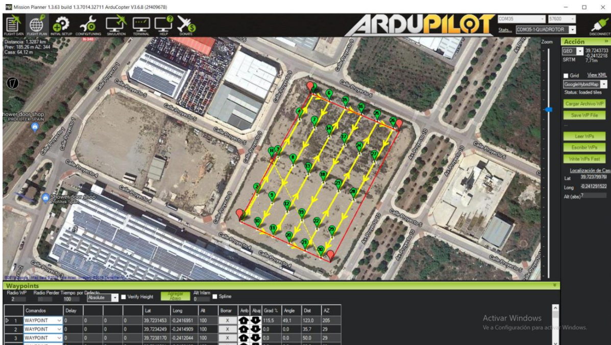
Figura 8.2 Programación de una misión automática en Mission Planner
