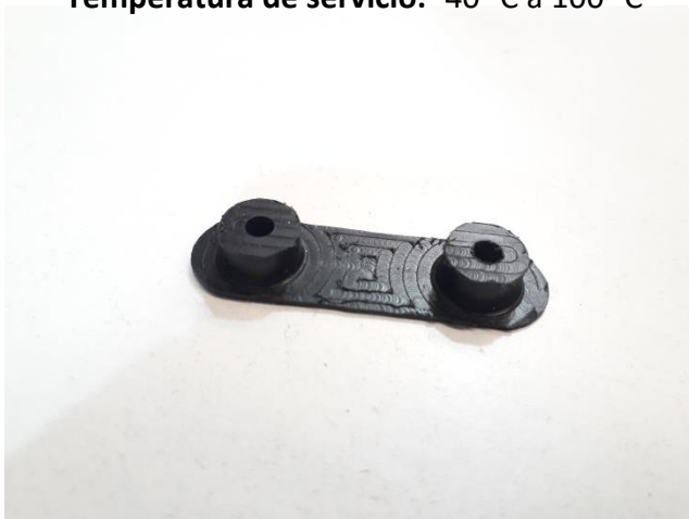
Figura 5.13 Acople de los motores en delrin
