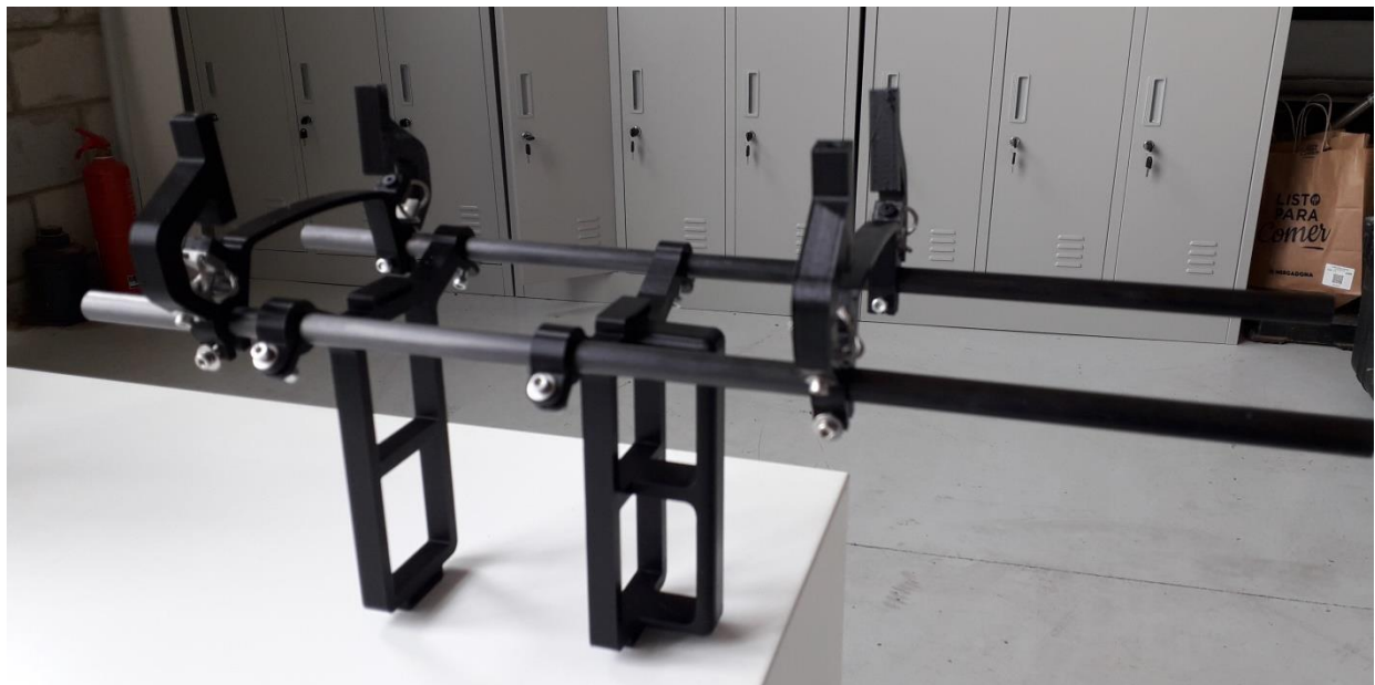
Figura 5.20 Estructura de las cargas de pago y soporte de baterías impreso en 3D 1
