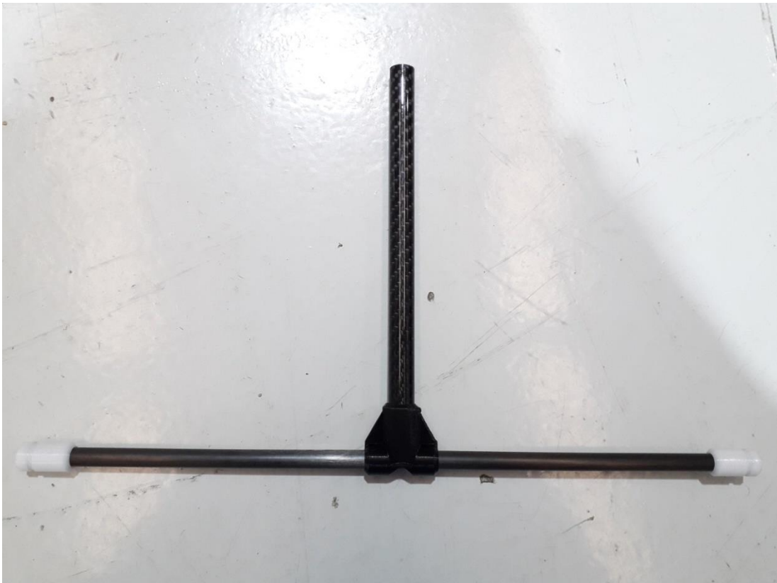
Figura 5.22 Estructura del tren de aterrizaje impresa en 3D 1
