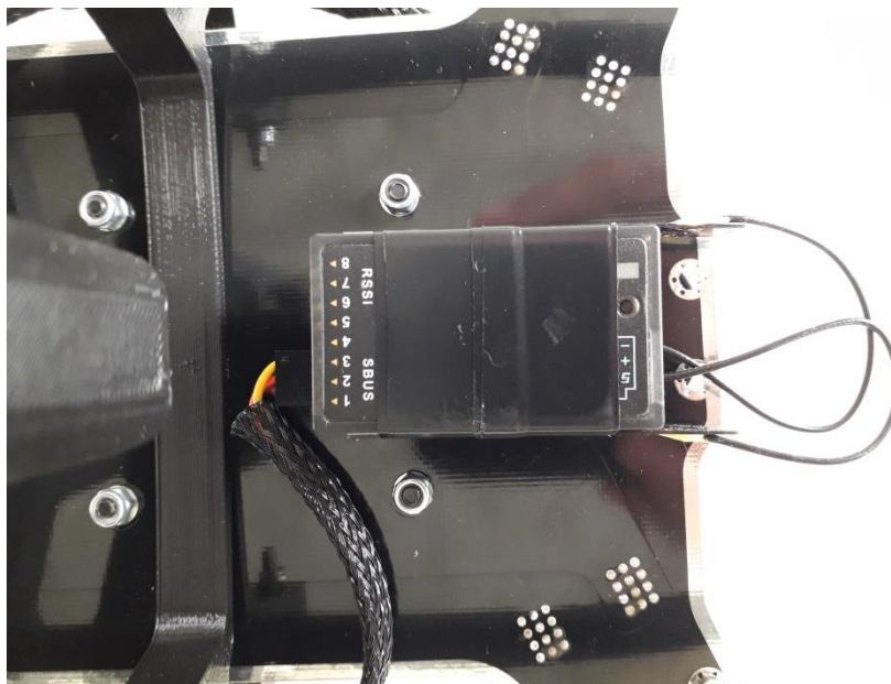
Figura 6.11 Receptor X8R montado en la parte inferior de la PDB
