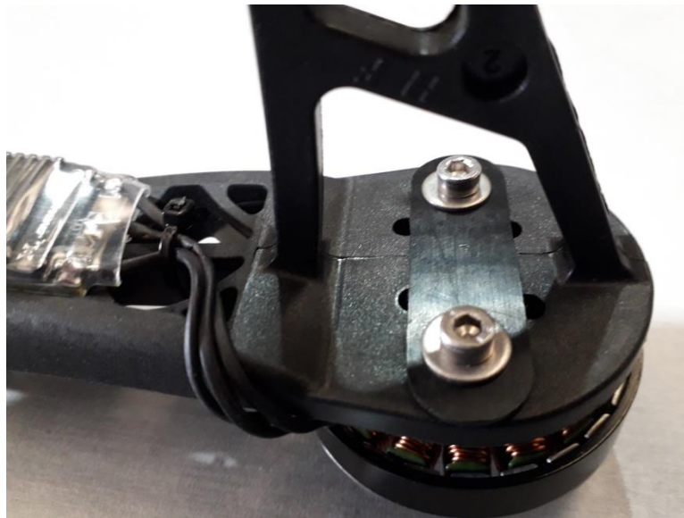
Figura 6.1 Acople del motor
