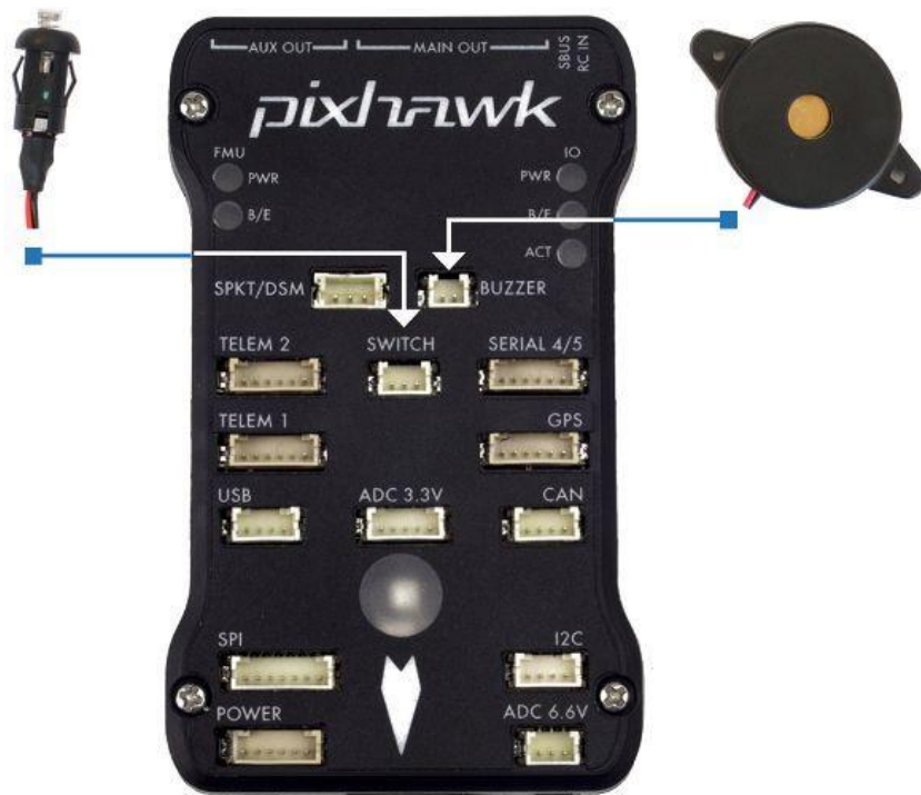
Figura 6.16 Entrada del Botón de Seguridad y el Zumbador
