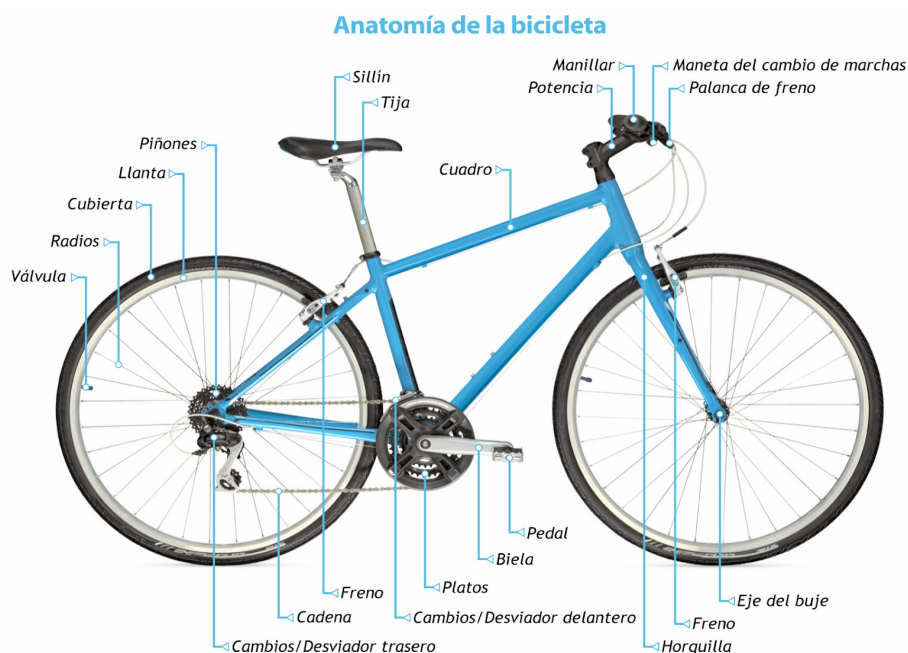
Figura 2.1. Componentes de una bicicleta. Fuente: < http://www.laspalmasenbici.org/p/anatomia-de-la-bici.html >
