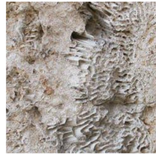
Figura 3.9_ Piedra conchífera cubana. Presencia notable de conchas calcáreas en su composición.
