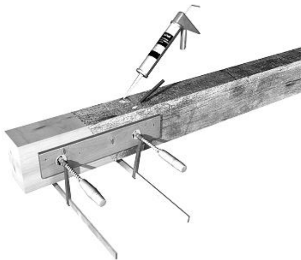
Figura 4.50_ Unión de prótesis de madera nueva a la viga preexistente.
