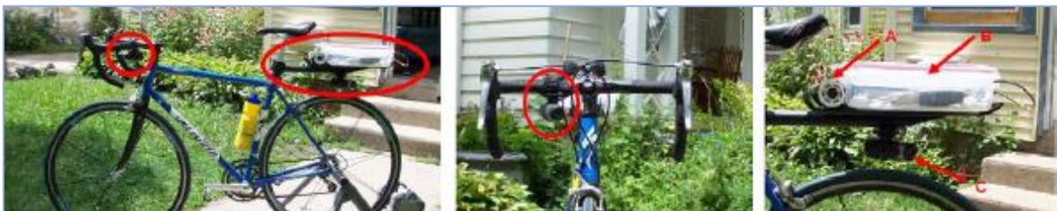
Fig. 26 Bicicleta Instrumental utilizada (Chapman & Noyce, 2012).
