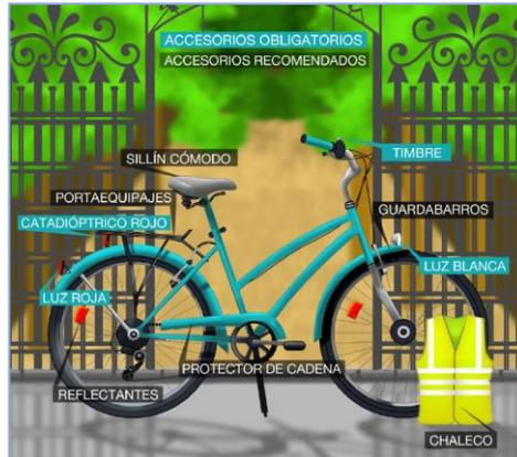
Fig. 12 Accesorios obligatorios y recomendados para la circulación de bicicletas (Dirección General de Tráfico, 2015).
