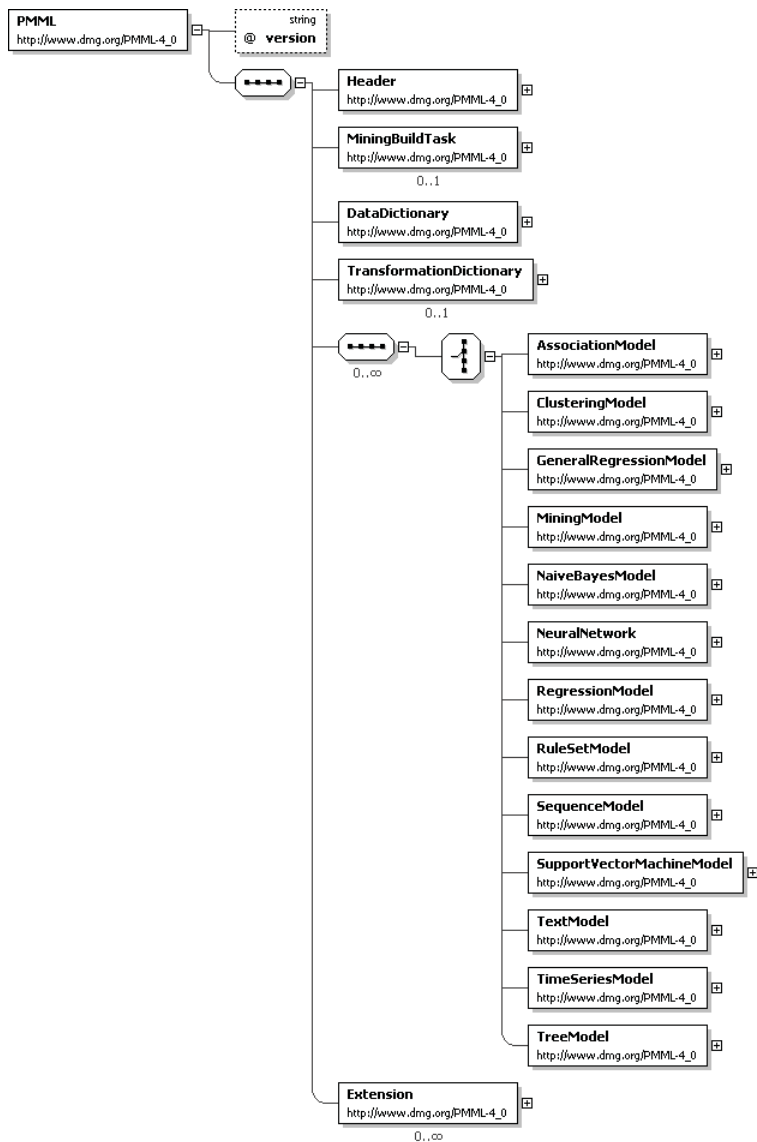
Figura 17.2: Diagrama de la marca PMML de un documento PMML, que contiene la especificación de los modelos predictivos.
