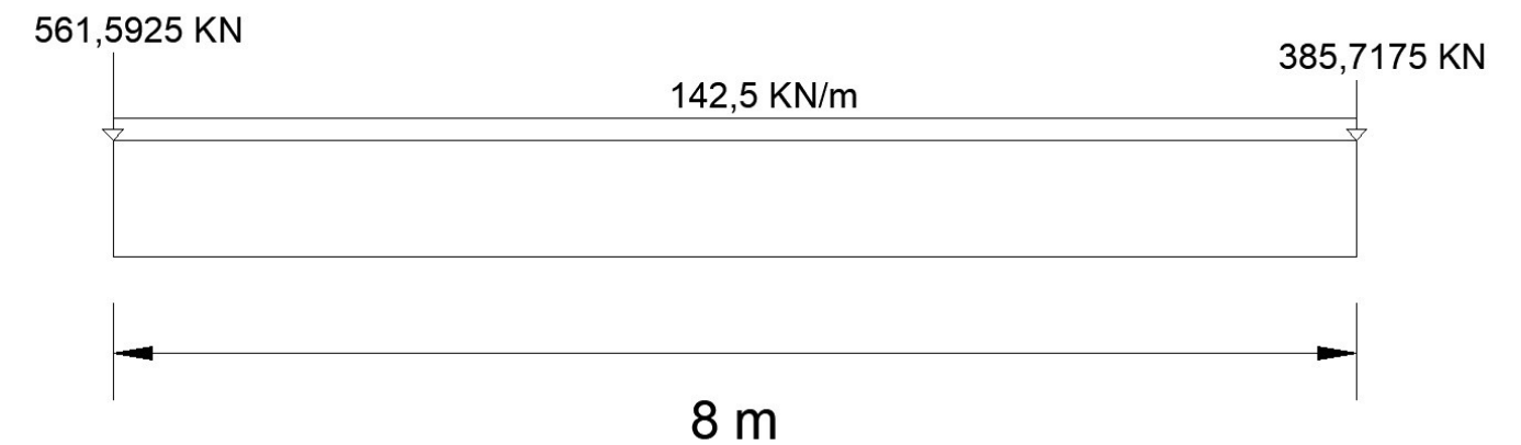
Figura 30. Modelización de las cargas actuantes sobre la losa de cimentación sin mayorar.
