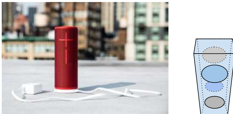
Figura 25: Altavoz Megaboom 3 de Ultimate Ears y esquema de estructura interna (fuente propia).
