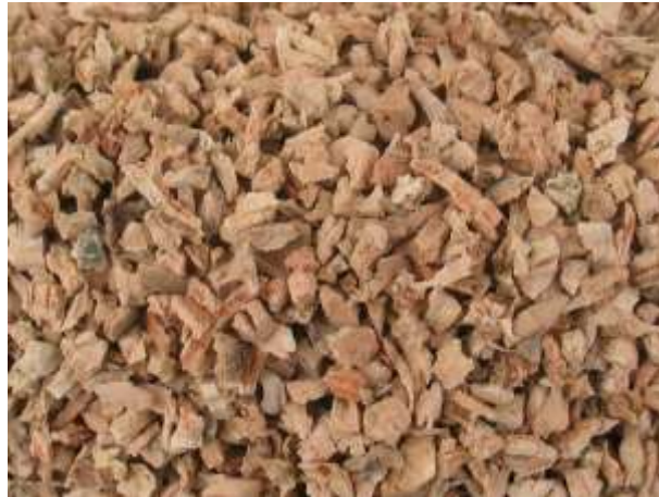
Figura 55: Granulado de corcho natural (Imporex, s.f.).
