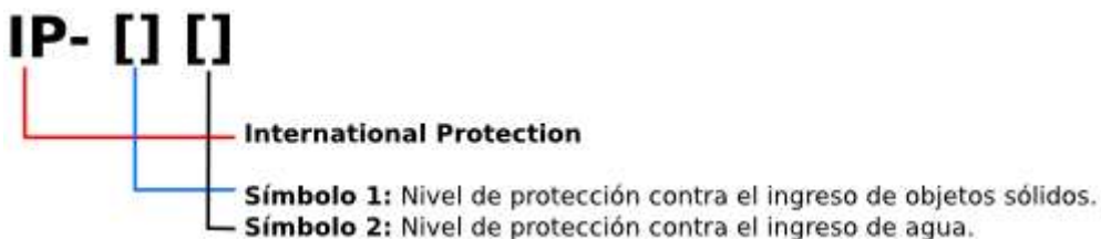
Figura 18: Esquema de referencia de grado de protección IP (ICM, 2016).
