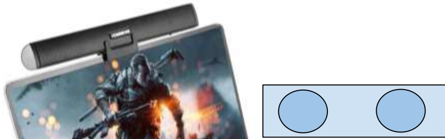
Figura 31: Barra de sonido Ikanoo de Acehe y esquema de estructura interna (fuente propia).
