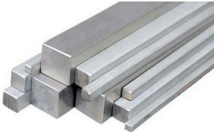
Figura 1: Ejemplo de aluminio extruido en bruto (Extralum, 2019).
