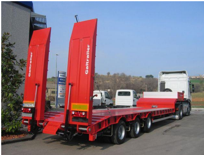
Figura 1 y 2. Camión góndola (semi-remolque). Distancia entre empresa de prefabricación y puerto de Benicarló
