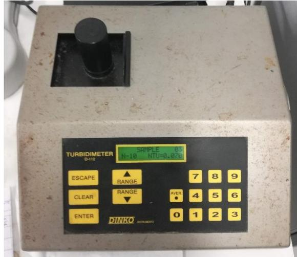
Figura 14. Medida de turbidez con turbidímetro
