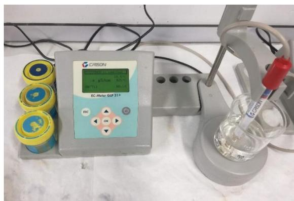
Figura 13. Medida de conductividad con conductímetro
