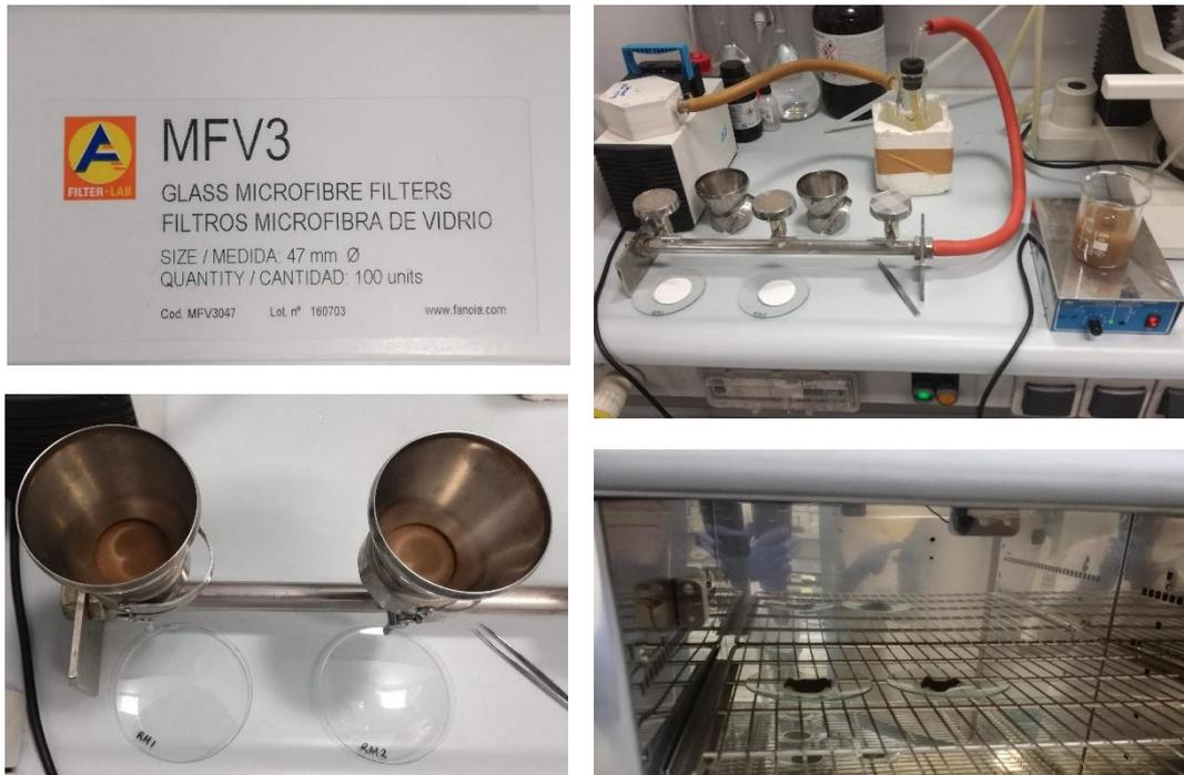
Figura 22. Proceso de determinación de los sólidos del licor de mezcla
