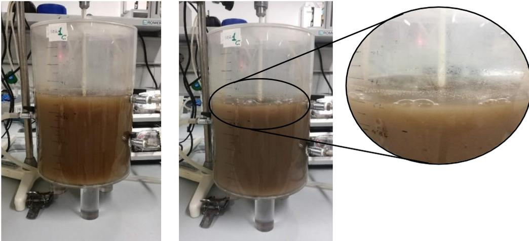
*Figura 7. Fases del ciclo. Reacción, en condiciones anóxicas y aerobias*
