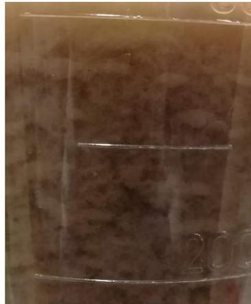
Figura 31. Flóculo abierto durante la sedimentación. Elevada concentración de SO<sub>3</sub><sup>2-</sup>
