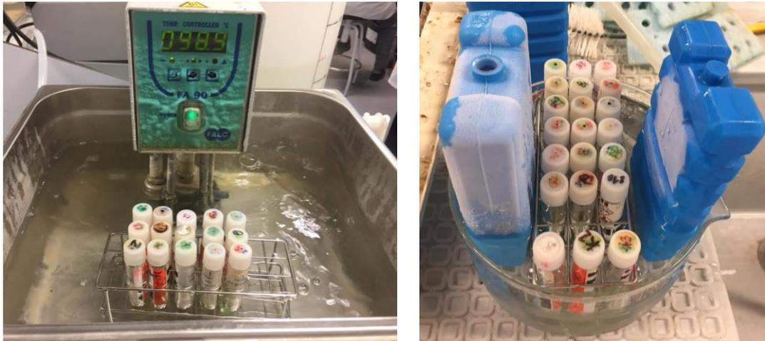
Figura 30. Baño a 100 °C y enfriamiento de las cubetas. Medidas de carbohidratos
