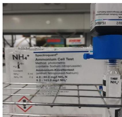
Figura 20. Preparación de la muestra para lectura de N-NH<sub>4</sub><sup>+</sup>
