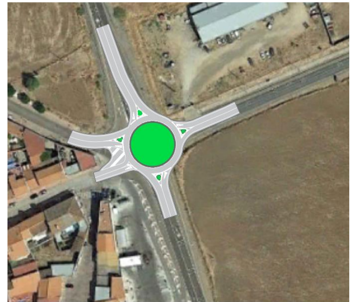
Figura 37. Planta general del trazado de la Alternativa 1. Elaboración propia.
