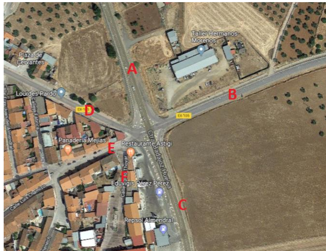
Figura 32. Croquis de patas de la intersección para mejor entendimiento del cálculo de niveles de servicio. Elaboración propia.
