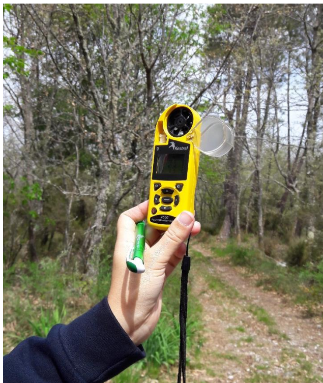
Figura 8. Medición de parámetros ambientales con el instrumento Kestrel 4500 Pocket Weather Track.
