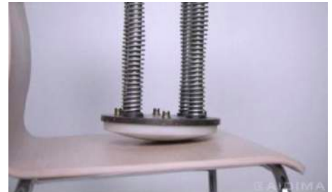
Fig. 3.6 Ensayo de resistencia a impactos
