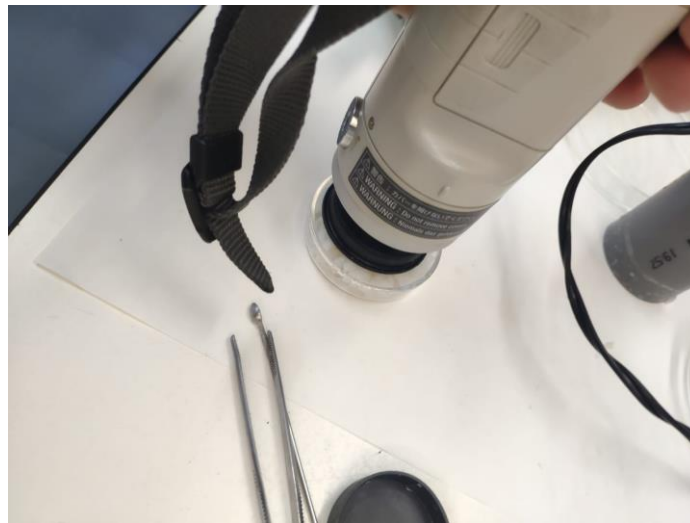
Figura 7. Ejemplo visual de la determinación del color en arroz con colorímetro Chroma Meter Cr-400
