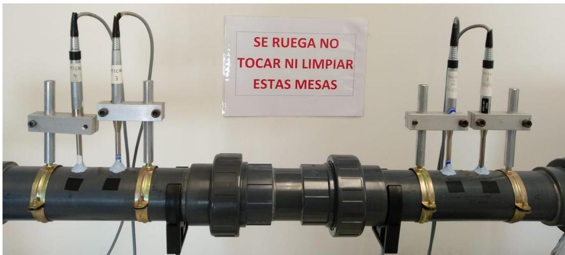
Ilustración 161: Detalle del portamuestras en el montaje del banco para la medida de la muestra de aire
