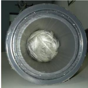
Ilustración 47: Interior de la terminación anecoica (relleno de fibras)
