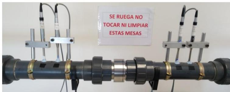
Ilustración 185: Detalle de la muestra en el montaje del banco para la medida de la muestra de fibra texturizada Owens Corning
