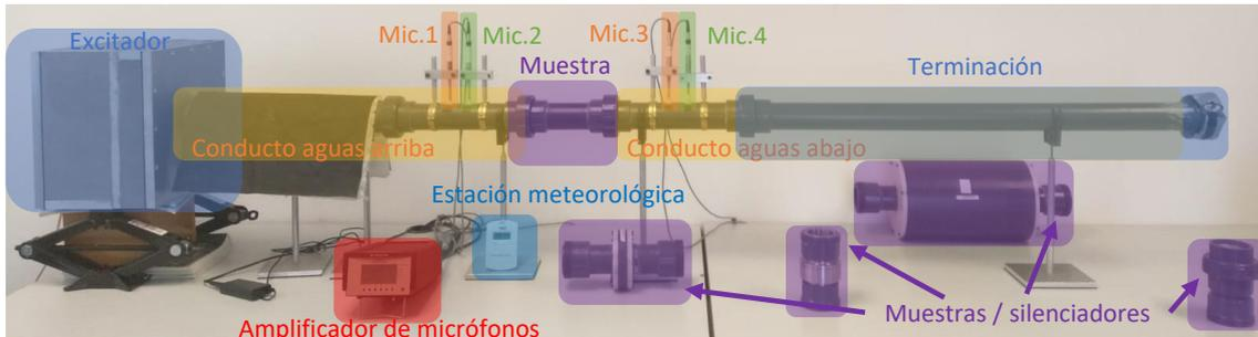
Ilustración 45: Banco de ensayos acústico utilizado (1/2): Componentes
