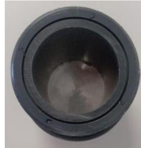
Ilustración 48: Interior de la terminación rígida (chapa de gran espesor de metal)
