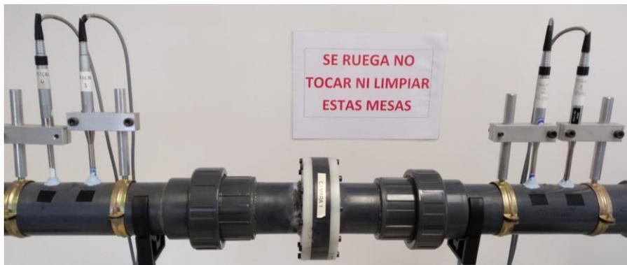
Ilustración 126: Detalle de la muestra en el montaje del banco para la medida de la muestra Cámara 1
