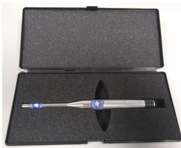
Ilustración 55: Conjunto micrófono-preamplificador
