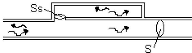
Ilustración 13: Esquema de un silenciador con rama lateral
