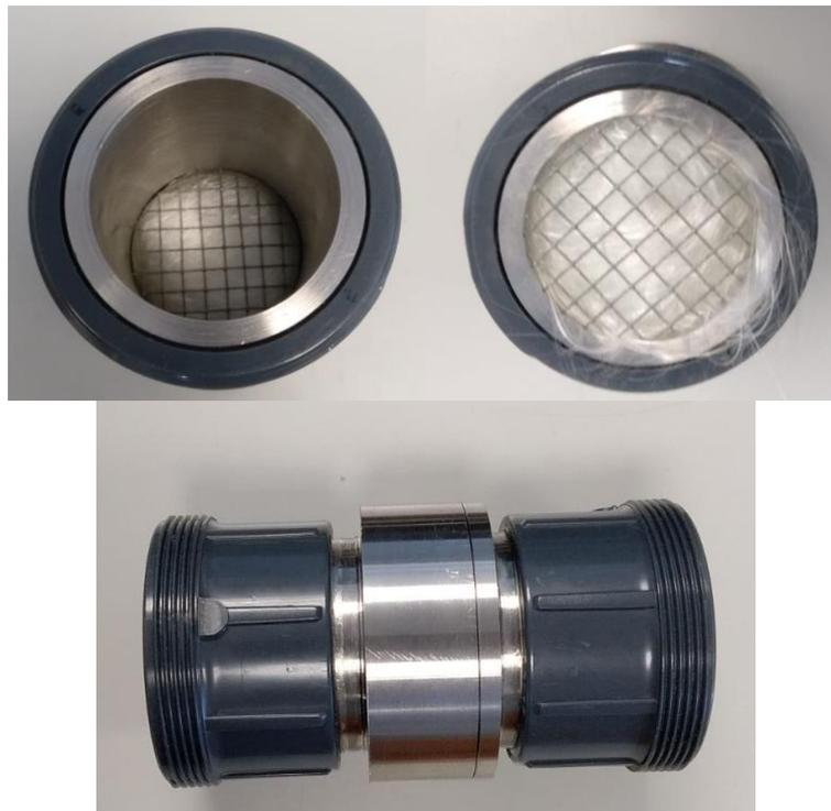
Ilustración 181: Portamuestras para el ensayo de la fibra texturizada Owens Corning. Vista de la entrada, salida y perfil, respectivamente
