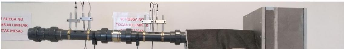
Ilustración 184: Montaje del banco para la segunda medida de la muestra de fibra texturizada Owens Corning
