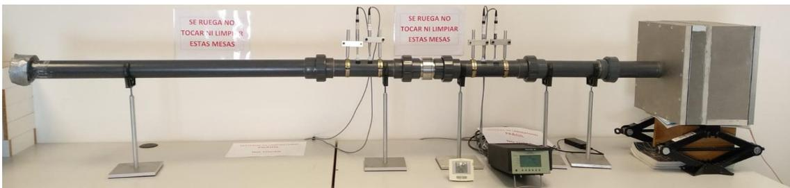
Ilustración 183: Montaje del banco para la primera medida de la muestra de fibra texturizada Owens Corning
