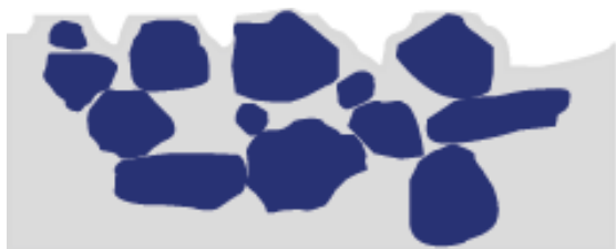
Fig. 21. CPVC adecuada, por encima del nivel necesario para formar una película continua.
