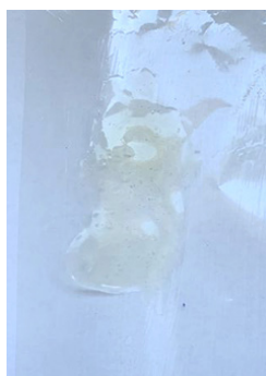
Fig 41. SAP2 tras los tres ciclos de envejecimiento.
