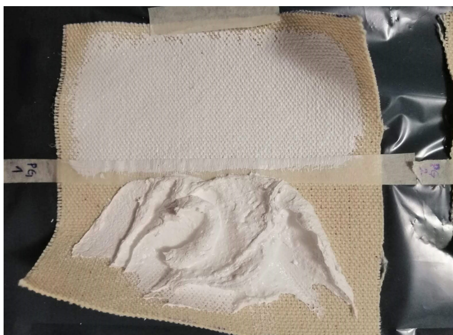
Fig. 38. Zonas diferenciadas de aplicación de la pintura en las probetas experimentales.
