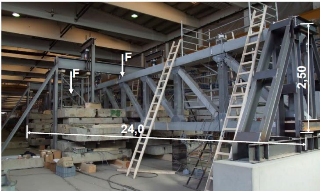
Figura 7. Configuración del prototipo de prueba de UHPC en escala real (Nguyen)
