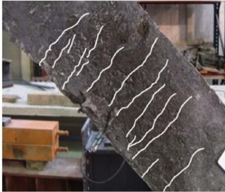
Figura 3. Patrón de fisuración de una diagonal traccionada al 2.5 % de deformación media (Serna, y otros, 2014).
