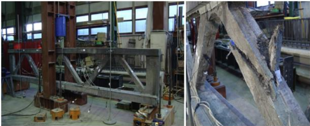
Figura 2. Configuración de ensayo de prototipo (izquierda) y rotura de la diagonal comprimida (derecha) (Serna, y otros, 2014)
