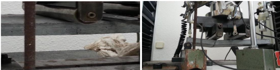
Figura 8. Fisura en muestra con fibras de vidrio de 36mm (Cordero, 2015)
