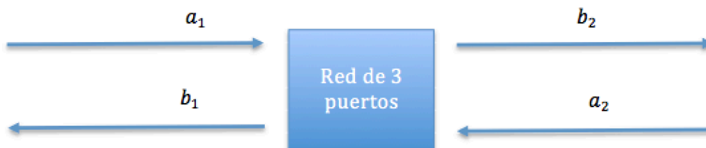
Figura 22 Esquema de una red de dos puertos con ondas incidentes y reflejadas
