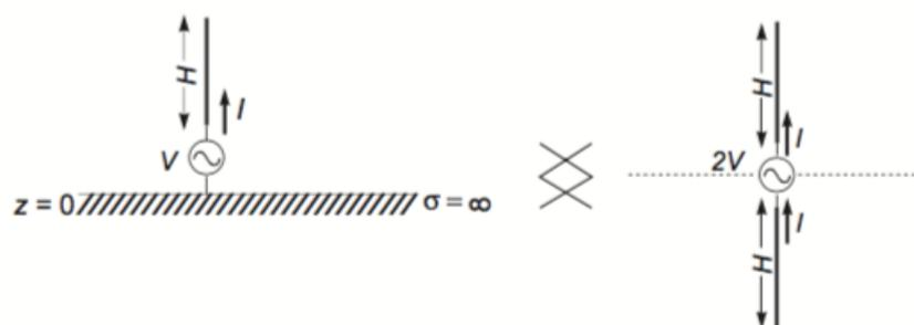
Fig. 11. Antena monopolo [23]
