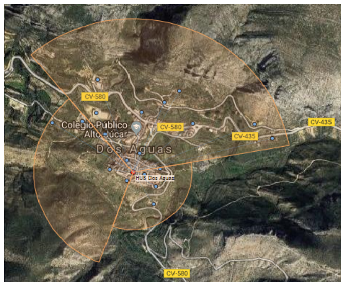
Figura 4.17: Enlace PMP desde el HUB de Dos Aguas hasta cada hogar.
