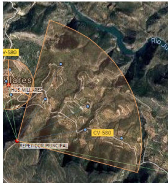
Figura 4.13: Enlace PMP entre HUB Principal y Millares (afueras).
