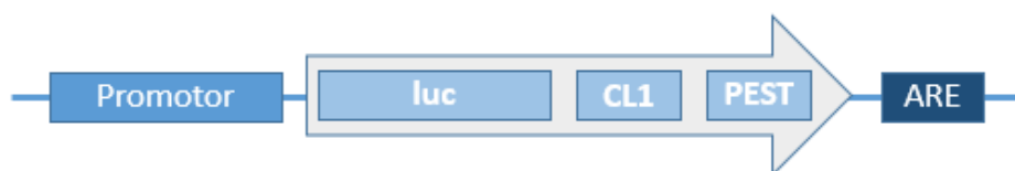
Figura 4. Representación esquemática de la construcción lucCP + de luciferasa. De izquierda a derecha se encuentra; el promotor de levadura que se quiere estudiar al que se le fusiona la construcción, seguido por la región codificante del gen de la luciferasa desestabilizada, con las secuencias CL1 y PEST que proceden de levadura y ratón respectivamente. Después, incluye la secuencia ARE para la desestabilización del ARNm.
