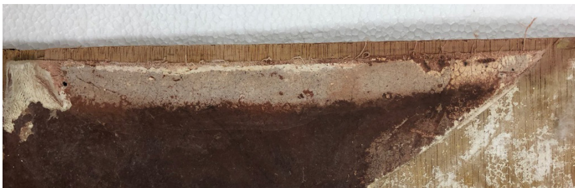
Figura 292: Resultado final del proceso de limpieza con las mezclas 4D y 1A tras evaporar los disolventes.
