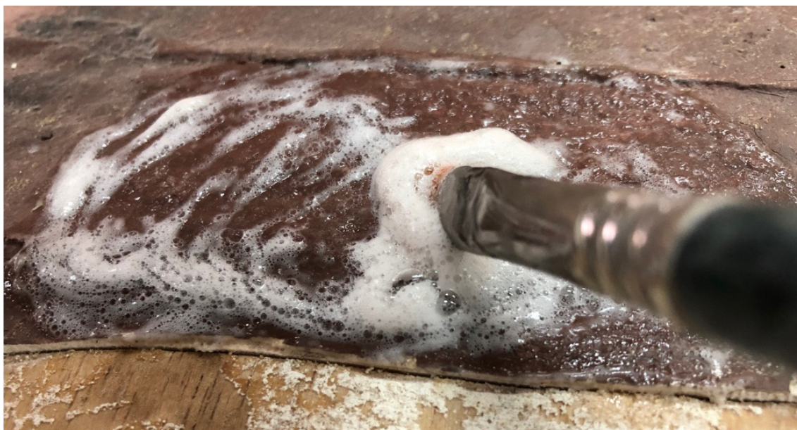
Figura 234: Detalle de la cantidad de espuma formada por la mezcla M al ser trabajada con el pincel sobre la superficie.
