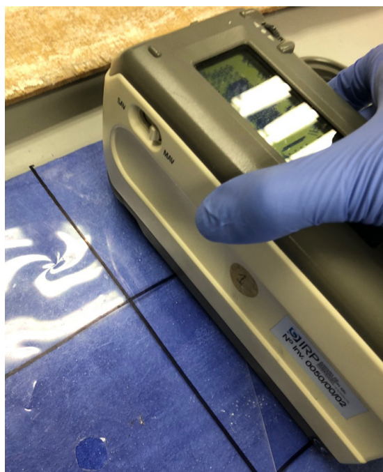
Figura 92: Imagen del empleo del espectrofotómetro de reflectancia Minolta CM-2600d en una de las probetas.
