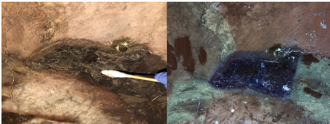
Figuras 340 y 341: Fotografías tomadas durante el proceso de limpieza con el sistema D. La radiación UV revela que se ha eliminado la capa de barniz.
