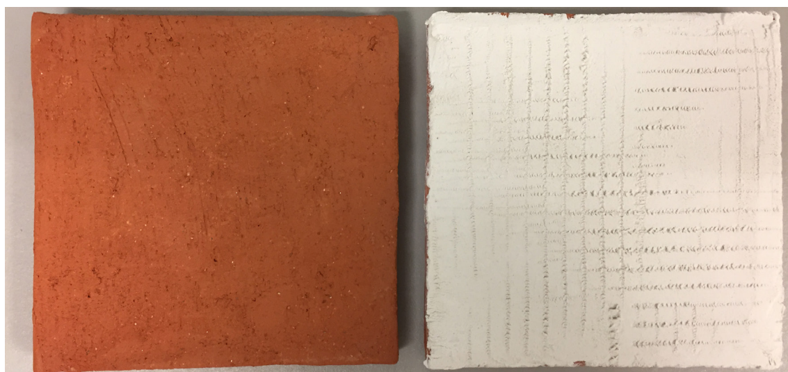
Figuras 86 y 87: Soporte poroso sin tratar (izquierda) y soporte poroso con estrato de sulfato cálcico (derecha)
