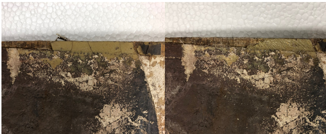
Figuras 279 y 280: Antes de intervenir (izquierda) y después de rebajar un poco la capa de cera con bisturí (derecha).
