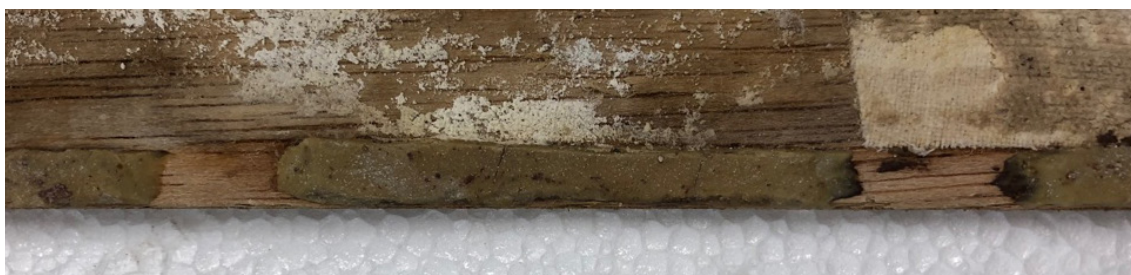
Figura 253: Fotografía tomada después de las pruebas de limpieza con los sistemas 1A izquierda y 4D derecha.
