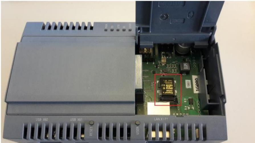
Cerrar el zócalo metálico y deslizarlo hacia arriba
