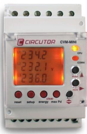
ILUSTRACIÓN 9-ANALIZADOR DE REDES FIJO PARA MONTAJE EN RIEL DIN-FUENTE: [10]
