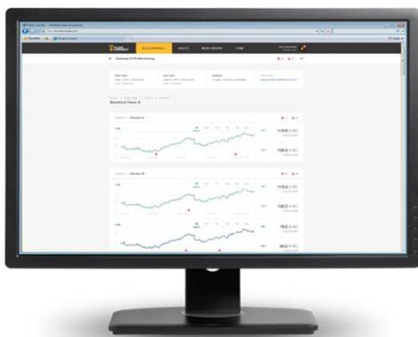
Con la aplicación Fluke Connect se puede acceder a los datos de monitoreo de los equipos de Fluke desde cualquier lugar y en cualquier momento. Detectar el desarrollo de fallas, recibir alarmas y ver un historial de rendimiento del equipo. Este software es compatible con el Monitor de potencia trifásico Fluke 3540 FC.
