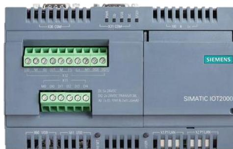
ILUSTRACIÓN 11-PASARELA ABIERTA DE SIEMENS SIMATIC IOT2040 – FUENTE: [11]
