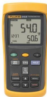
**ILUSTRACIÓN 8-MEDIDOR Y REGISTRADOR PORTÁTIL DE TEMPERATURA - FUENTE: [9]**
