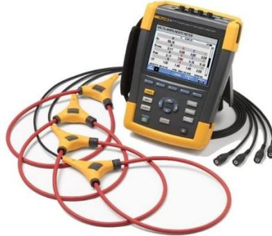
**ILUSTRACIÓN 7-ANALIZADOR DE REDES PORTÁTILES - FUENTE: [9]**
