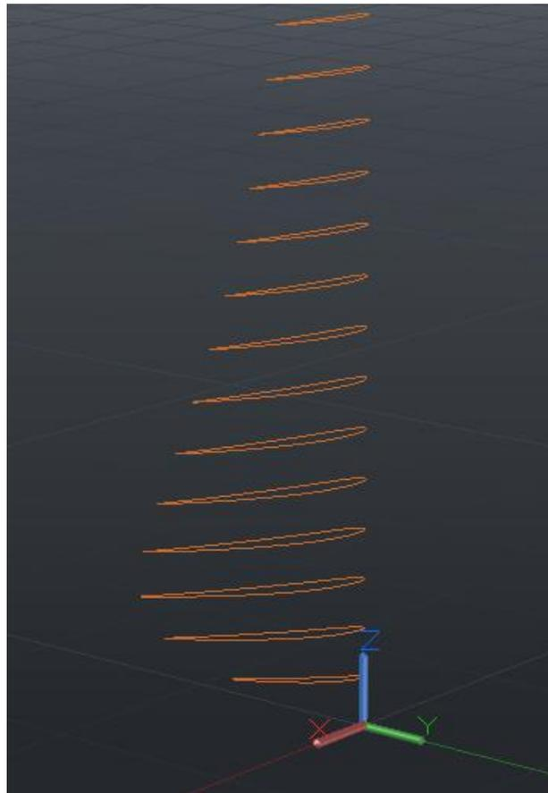
Ilustración 28: Modelado de los perfiles de la pala para cada sección
