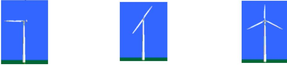
Ilustración 25: Aerogeneradores monopala, bipala y tripala [37]
