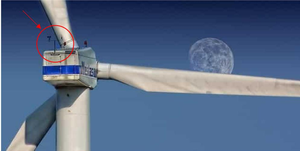
*Il·lustració 33: Sistema de anemòmetres en un aerogenerador Vestas [45]*
