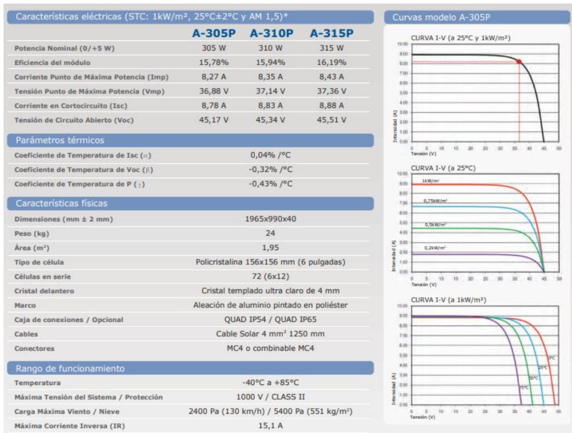
Imagen 2.13.1 – Características Panel Fotovoltaico Atersa A-305P. Fuente: Atersa , Elecnor
