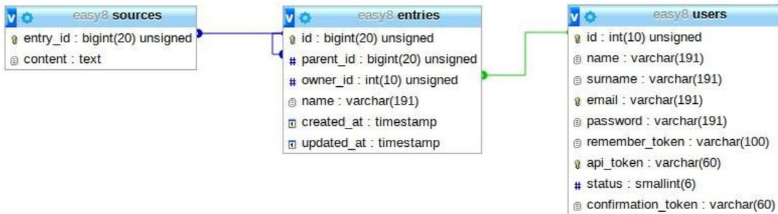
**Figura 9: Esquema de la base de datos**
