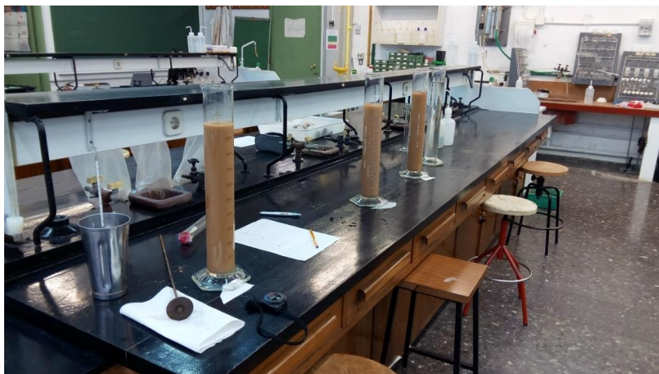
Figura 3: Detalle del ensayo de textura en laboratorio.
