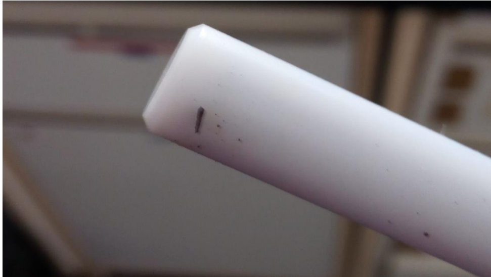
Figura 5: Detalle de la medida de pH: el cilindro blanco es un imán, el cual atrae a alguna sustancia presente en el suelo.
