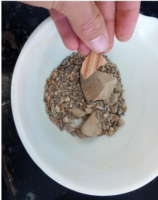
Figura 10: Detalle de la fracción gruesa; se muestra trozo de ladrillo encontrado en las muestras de suelo.
