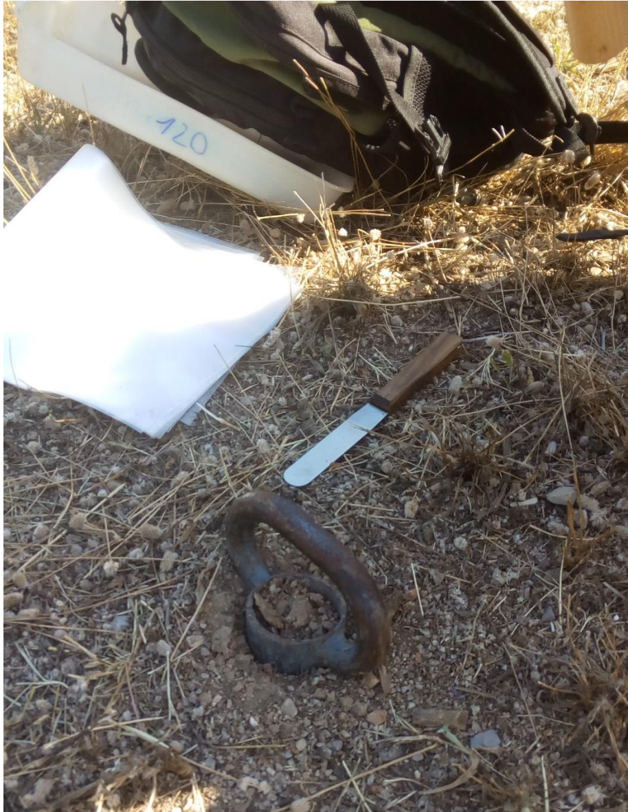
Figura 8: Detalle de la sonda con la que se recogieron las muestras para medir la densidad aparente.
