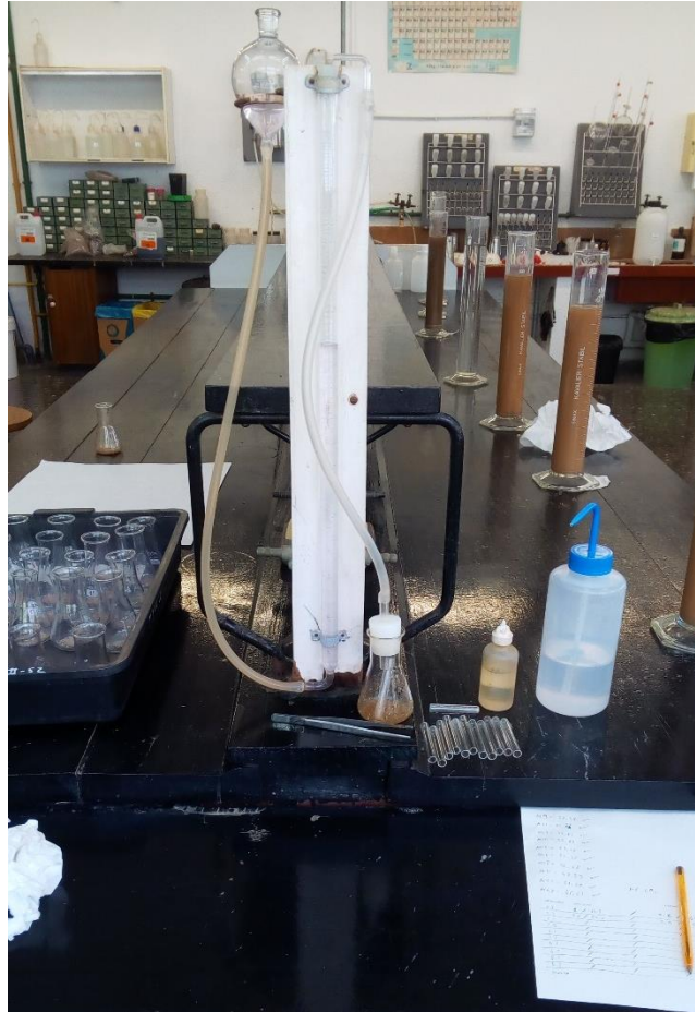
Figura 7: Detalle del calcímetro en el laboratorio de Edafología.
