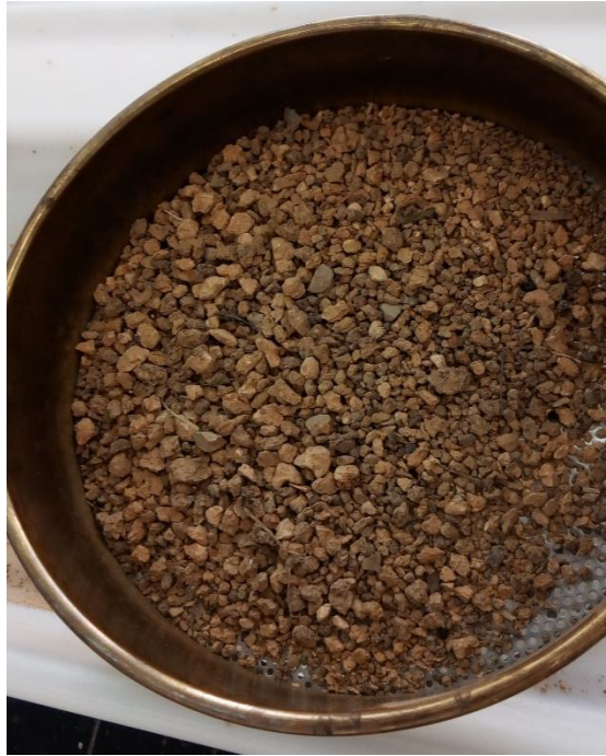
Figura 9: Detalle del proceso de tamización de los elementos gruesos.
