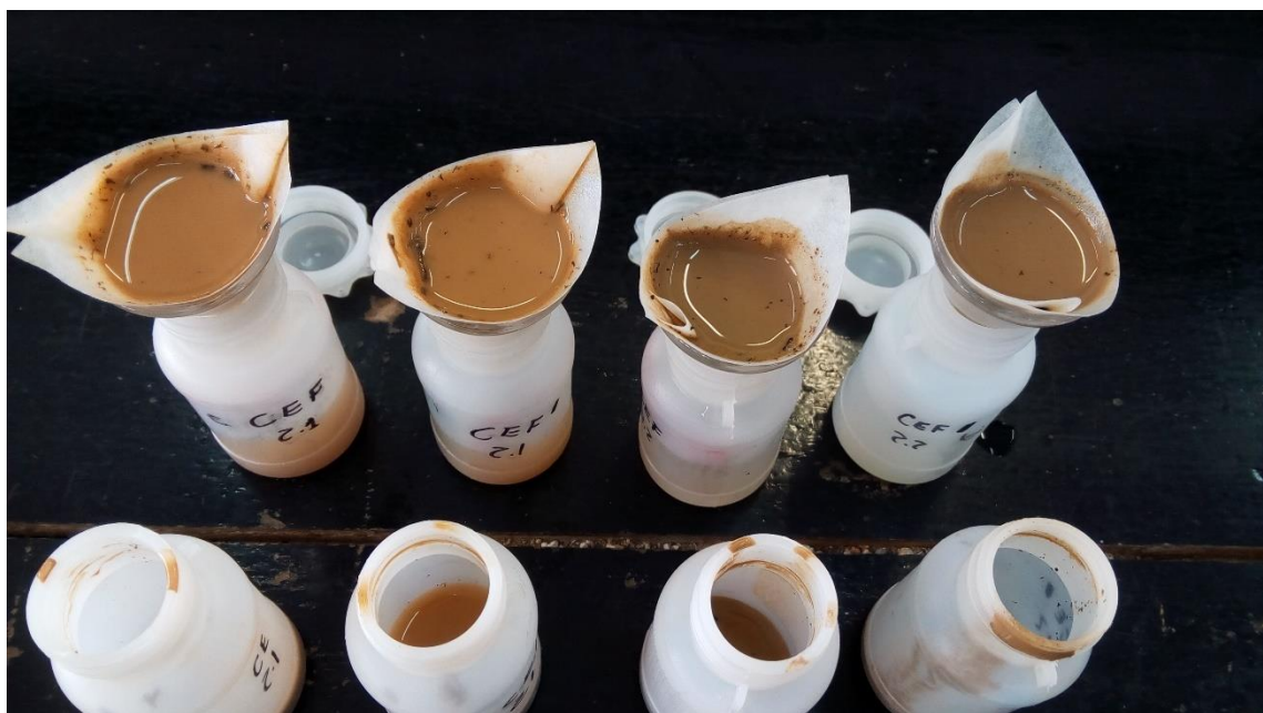
Figura 4: Detalle del proceso de filtración para caracterizar la salinidad de las muestras.
