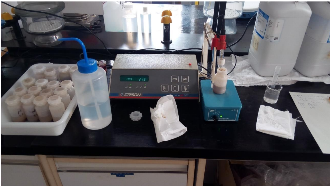
Figura 6: Detalle del equipo de medida del pH: micro-pHmetro 2001 Crison®.
