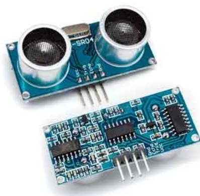
Ilustración 19 - Sensor de ultrasonidos
