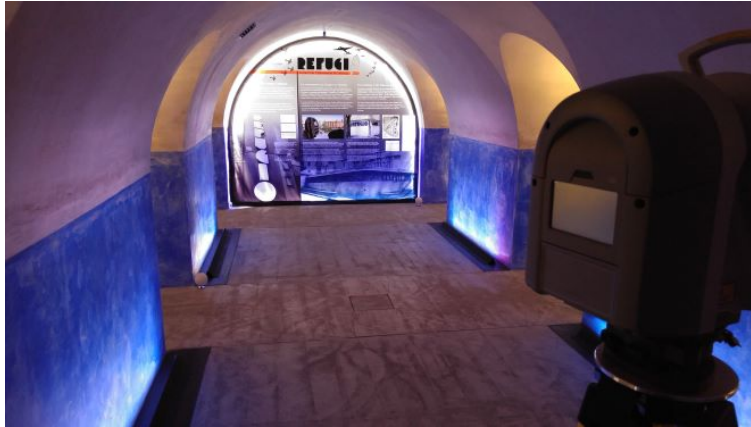
Figura 8. Trimble TX6 ubicado dentro del Refugio
