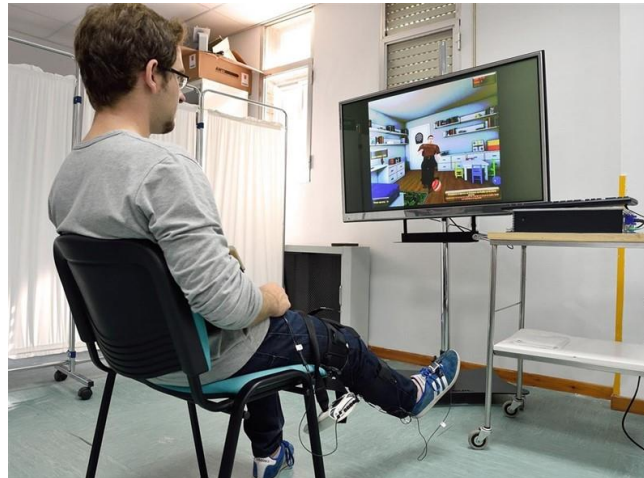
Ilustración 8. Sistema de rehabilitación TRAM desarrollado por Indra. En la imagen se pueden observar los sensores colocados sobre la paciente, así como la pantalla donde se visualiza el movimiento a realizar.
