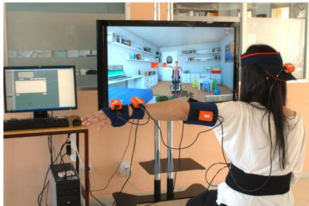
Ilustración 7. Sistema de rehabilitación TOyRA desarrollado por Indra. En la imagen se pueden observar los sensores colocados sobre la paciente, así como la pantalla donde se visualiza el movimiento a realizar.
