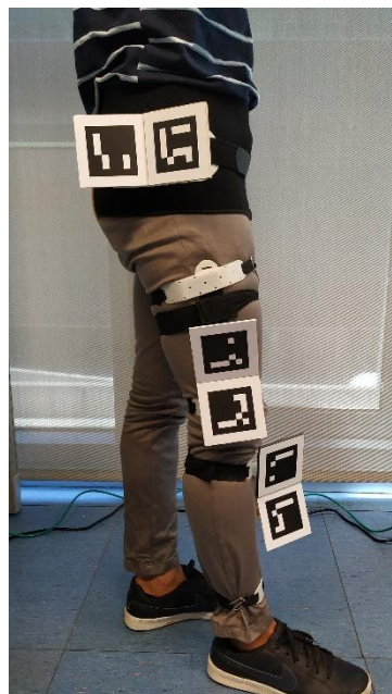
Ilustración 20. Diseño del sistema de fijación para el seguimiento de tres segmentos corporales del tronco inferior.
