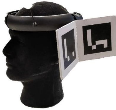
Ilustración 19. Diadema con sistema de marcadores para ejercicios de cuello. Se pueden observar los marcadores de realidad aumentada ArUco.
