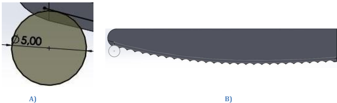
Figura III.12. A) Croquis de un diente. B) Hoja de sierra sin estrías.
