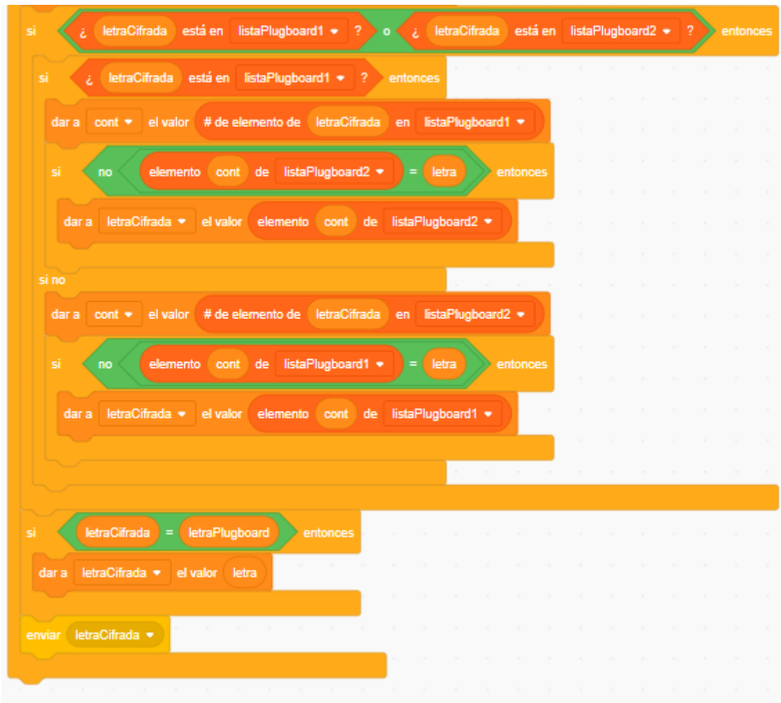
Figura 5.31: Cuarta y última parte del código de cifrado. Una vez que hemos cifrado la letra, tenemos que comprobar si la resultante está cableada en el clavijero. Para ello, verificamos si la letra cifrada está en 'listaPlugboard1' o 'listaPlugboard2'. En caso afirmativo, comprobamos que la letra a la que está conectada no es la misma que la original, y le damos ese nuevo valor a 'letraCifrada'. Esto último se debe a que puede darse el caso de que una letra se cifre por otra a la que está conectada, formando un bucle. Por ejemplo, si 'A' se cifra por 'B' y hay una conexión 'BA', se ignoraría el cableado, debido a que una letra no se puede encriptar por ella misma. Finalmente, se enviaría el mensaje 'letraCifrada' (no confundir con la variable homónima).
