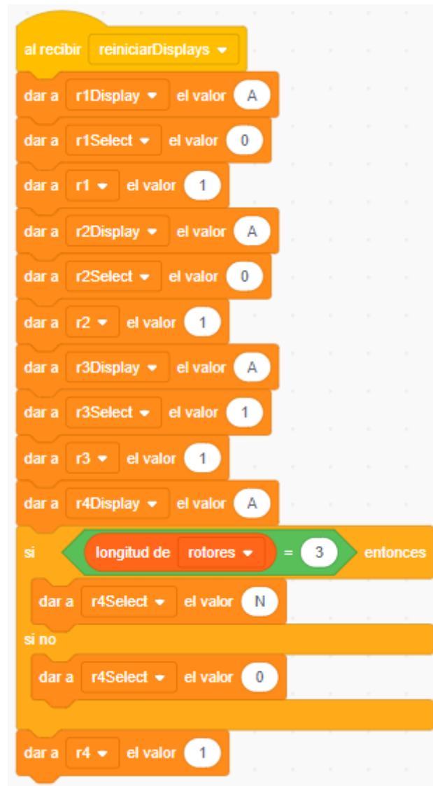
Figura 5.39: Evento que reinicia todos los displays, bien cuando hemos seleccionado nuevos rotores, o bien cuando hemos cambiado de orden los que ya teníamos.
