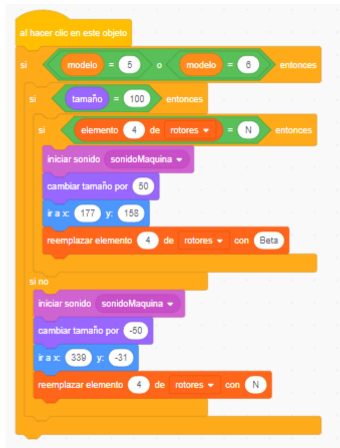
Figura 5.45: Grupo de bloques encargado de colocar un rotor para su uso. Este es el específico para los rotores Beta y Gamma. Si pulsamos en el rotor, el modelo ha de ser de una máquina M4 (5 o 6). Una vez verificado esto, si el tamaño es 100 y no hay ningún rotor ocupando la cuarta posición, se coloca en dicho lugar y se añade el nombre del rotor a la lista 'rotores'. Si el tamaño no es 100, entonces debemos devolver el rotor a su posición inicial y eliminarlo de la lista 'rotores'.
