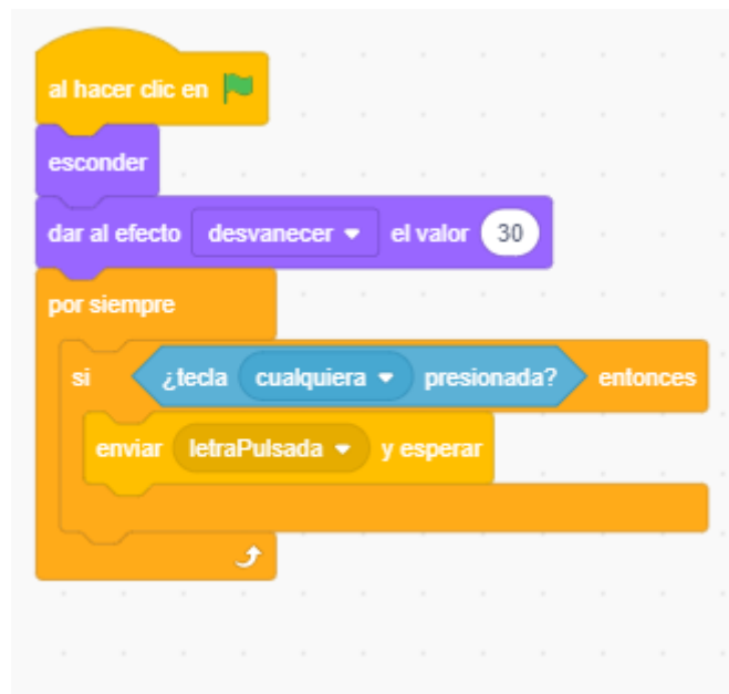
Figura 5.26: Bloques que se ejecutan al inicio del simulador. El efecto 'desvanecer' le da un toque estético, mientras que el bucle infinito hace que solo se pueda pulsar una tecla al mismo tiempo.
