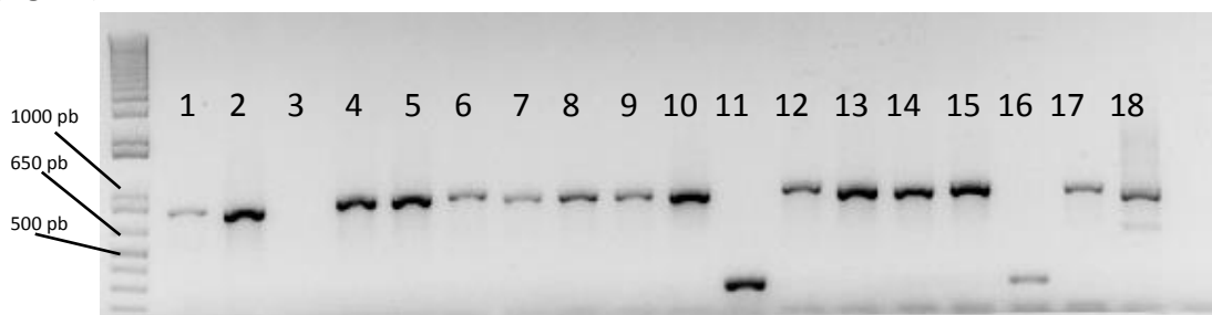
Figura 15. Testado en agarosa al 1% de los productos de PCR de 18 colonias y el control negativo tras la clonación por TOPO® TA Cloning®. Peso molecular 1 Kb Plus DNA Ladder.
