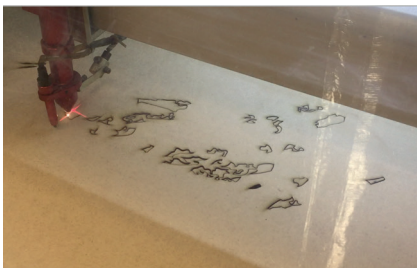
25. Miriam Mallea, Sin título. 2019. Proceso de la cortadora láser sobre tablero de DM de 3mm.
