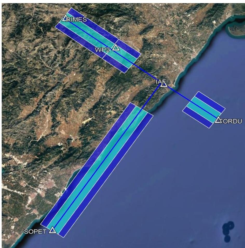
Ilustración 38. Llegada con sus áreas de protección en planta. Elaboración propia
