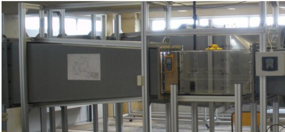
Figura 1.3: Tobera divergente y cámara de ensayos del túnel de viento subsónico, de [4]
