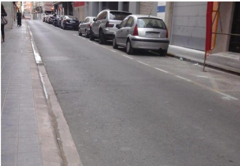
Imagen 158. Foto de calzada de vehículos con rigola al mismo nivel que el adoquinado
