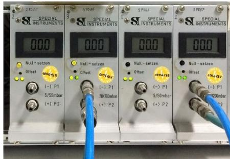
*Fig. 30 - Transductores de presión diferencial*
