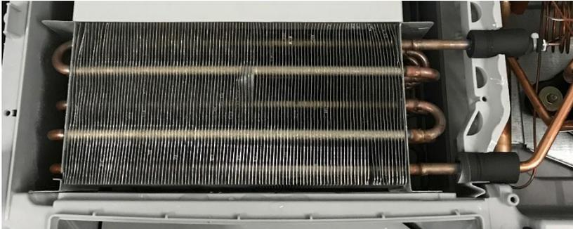
*Fig. 14 - Evaporador típico en secadora*
