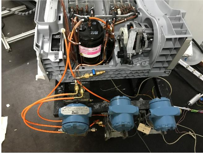
*Fig. 25 - Sistema de medida de presión instalado*
