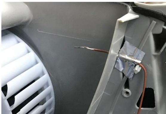
*Fig. 24 - Sonda de temperatura en el canal de aire (salida del ventilador)*
