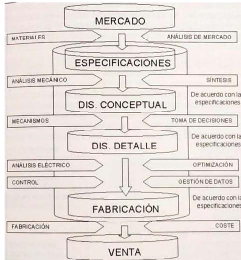
Figura 1: Proceso de diseño según Pugh. Fuente: Libro fundamentos del diseño en la ingeniería
