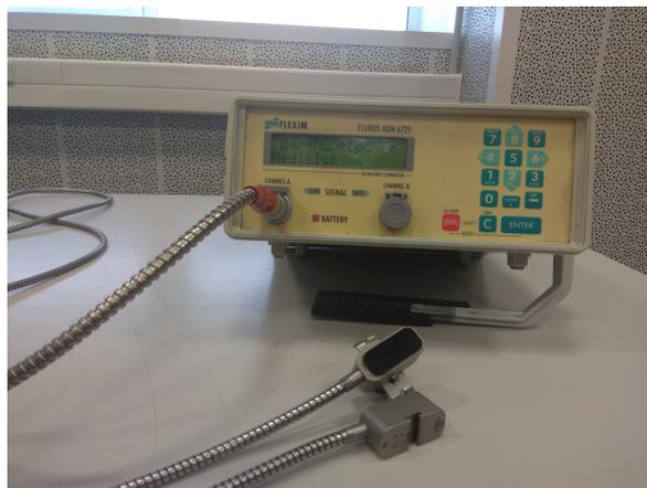
*Figura 3.5: Caudalímetro de ultrasonidos*
