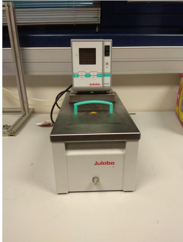
*Figura 3.8: Termostato utilizado en la instalación*
