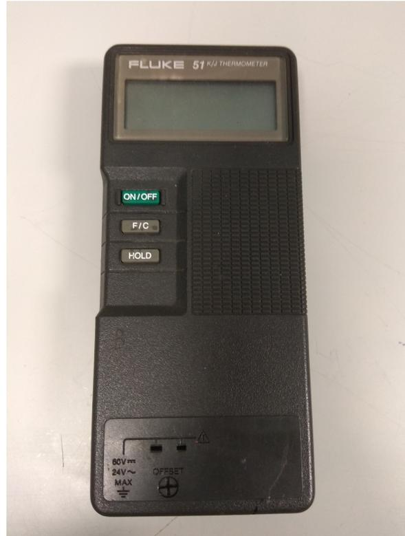
*Figura 3.10: Display lector de termopar*
