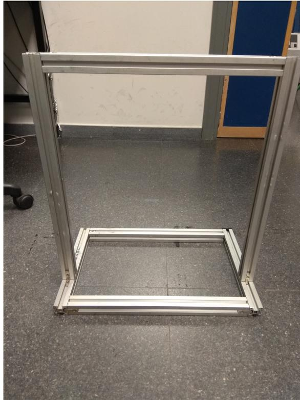
*Figura 3.9: Estructura de perfiles de aluminio*
