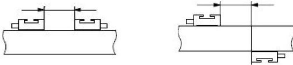
*Figura 3.11: Izquierda: Transductores colocados en el mismo plano Derecha: Transductores colocados contrapuestos*
