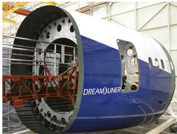
Figura 2.2: Sección de fuselaje del B787 (Davies, 2013).
